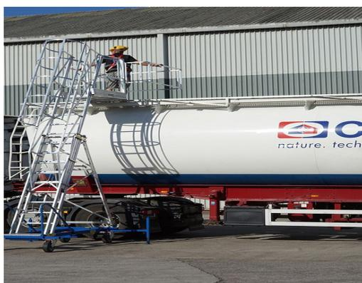
En esta foto podemos ver, como debe realizarse de forma segura la descarga del aceite, y, que elementos debe utilizar el transportista de la empresa X.
