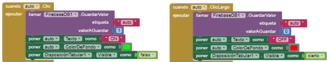
Figura 57 PROGRAMACIÓN DEL PULSADOR DE MODO AUTOMÁTICO
