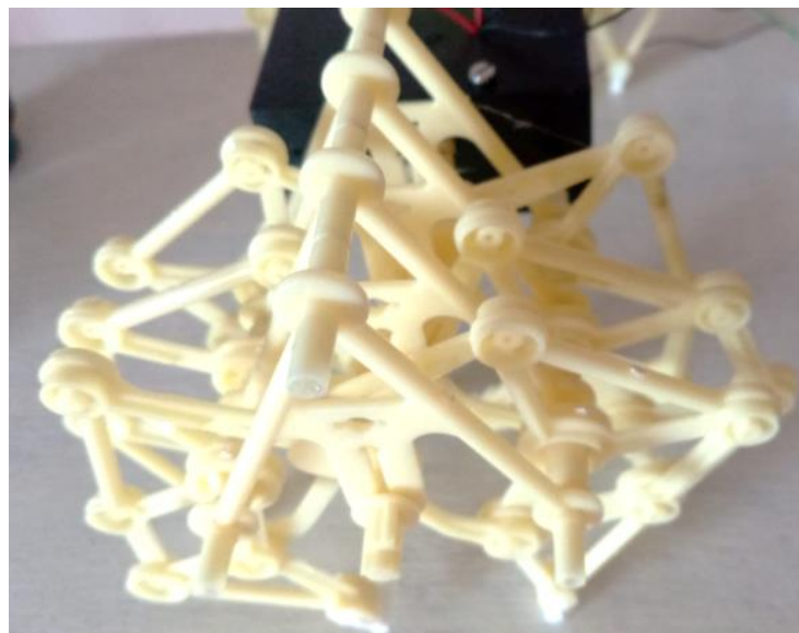
Figura 24 ESTRUCTURA THEO JANSEN ENSAMBLADA
