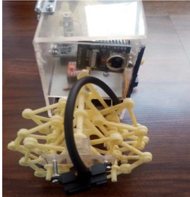
Figura 38 INSTALACIÓN DE CÁMARA LATERAL
