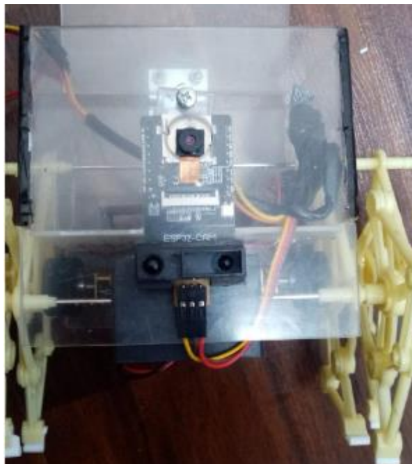
Figura 37 INSTALACIÓN DE CÁMARA FRONTAL
