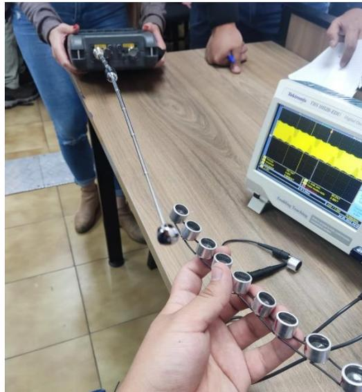
*Figura 49. Espectrómetro realizando las medidas de la onda de ultrasonido emitidos por los piezoeléctricos. Autores.*
