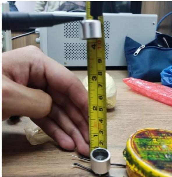
*Figura 42. Transductores piezoeléctricos colocados cara a cara. Autores*
