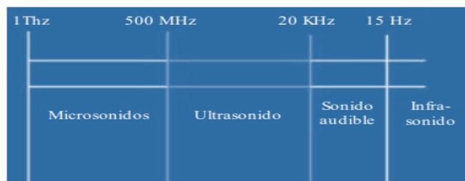
Figura 15. Espectro de vibraciones ultrasónicas. Fuente: [22]
