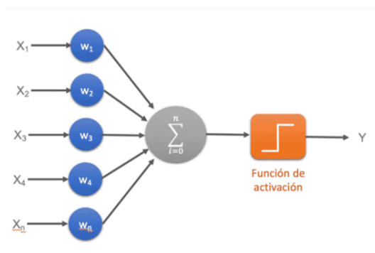
Figura 3.1: Perceptrón o neurona artificial con varios canales de entrada y 1 salida.
