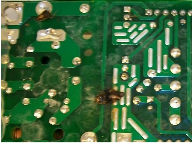
Fig. 2. Presencia de insectos en pistas con alta tensión
