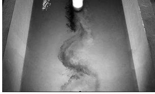
Figura 3.- Visualización de las estructuras del flujo para un caudal 40 l/s en cada tributario
