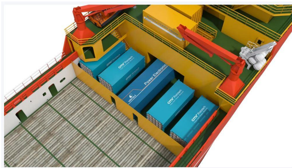
Fig. 2.5.1: Ubicación del sistema de propulsión mediante pila de amoníaco en la cubierta principal del OSV “Viking Energy”. (Vessel Performance Optimisation (VPO), 2020)
