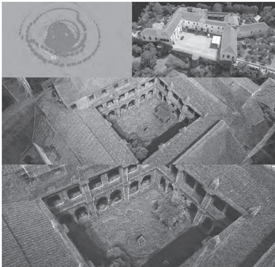
Fig. 7. Por ordem de imagens da esquerda para a direita e de cima para baixo: Alinhamento de fotografias, nuvem de pontos, pormenor da nuvem de pontos 1, pormenor da nuvem de pontos 2.
