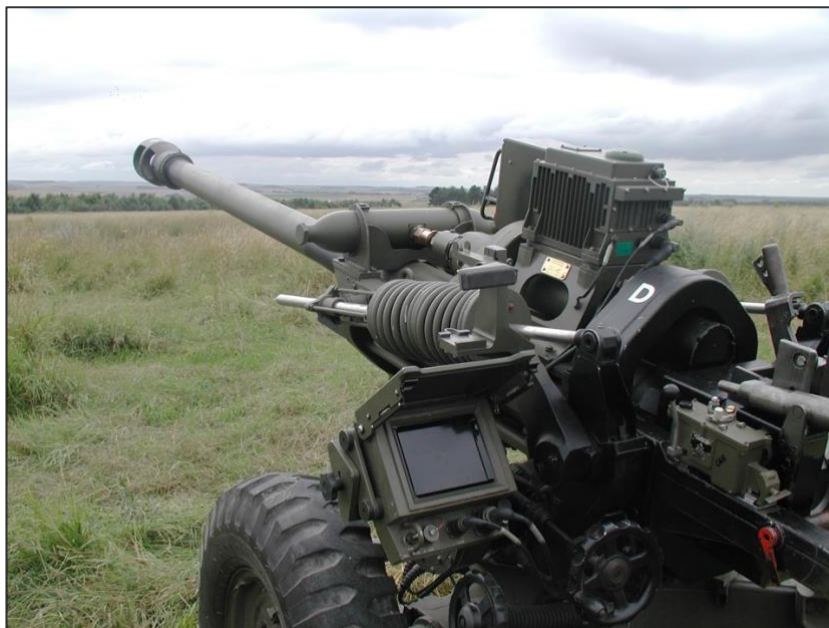
Figura nº 2 - Sistema LINAPS acoplado num obus M119 LightGun
