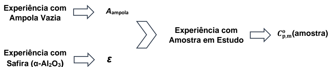
Figura 2.8. Esquematização do procedimento para a determinação de C_{p,m}^0 de um determinado composto em estudo, utilizando o calorímetro de drop apresentado.
