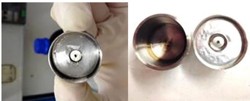
Figura 3.15. Imagens da célula de Knudsen após uma experiência de efusão de um líquido iónico.
