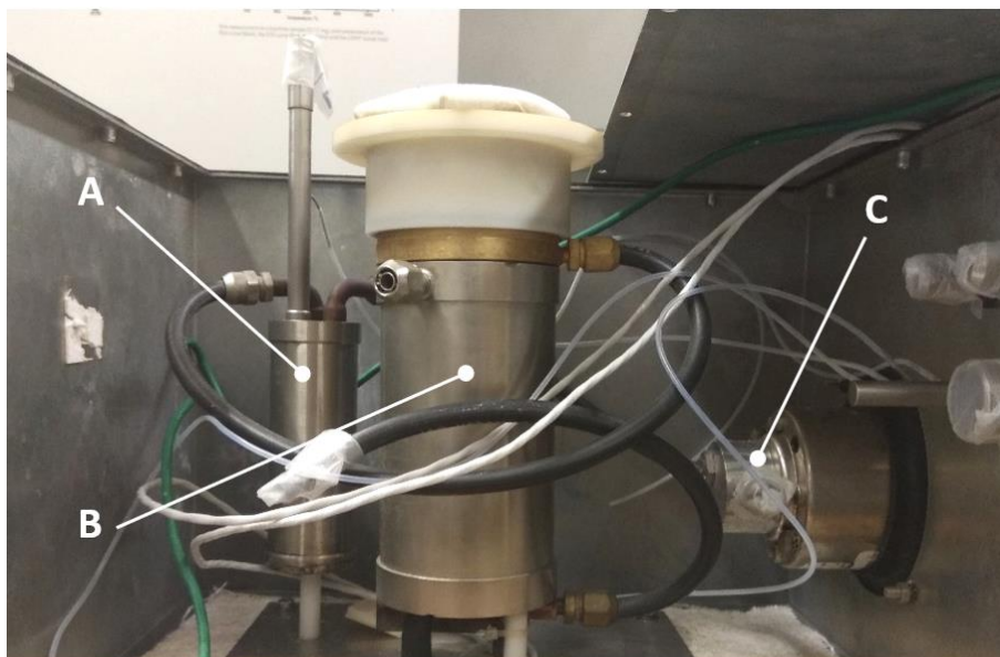
Figura 4.1. Fotografia da caixa do calorímetro no início da sua reparação. A - Vaso expensor do fluido térmico, B – Vista exterior do bloco calorimétrico, C – Cabeça da bomba de circulação do fluido térmico “I”.
