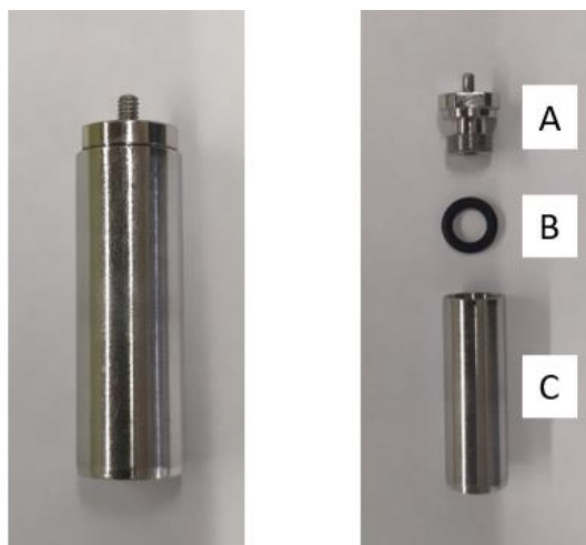
Figura 3.16. Fotografia da célula do tipo “ batch ” utilizada no micro DSC III. A - tampa, B - o-ring em Viton, C - corpo da célula
