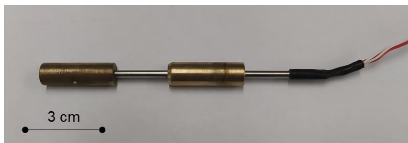
Figura 4.11. Bloco emulador da célula calorimétrica e Pt100 utilizada para a calibração de temperatura.
