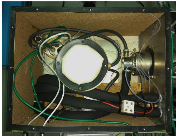
Figura 4.8. Fotografia do interior da caixa do calorímetro após isolamento das tubagens.
