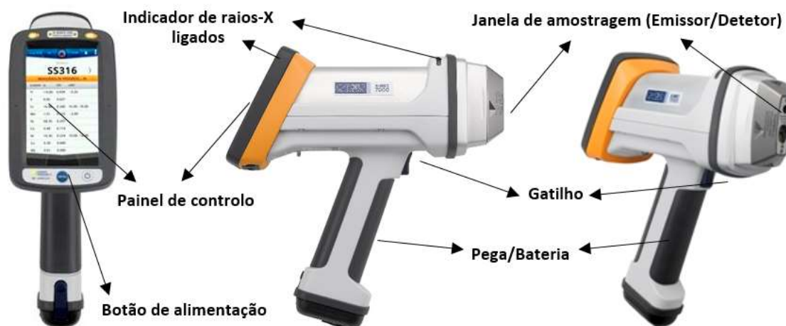
Figura 12 - Componentes básicos do Espetrómetro de Fluorescência de Raio-X, X-MET7000 Series.
