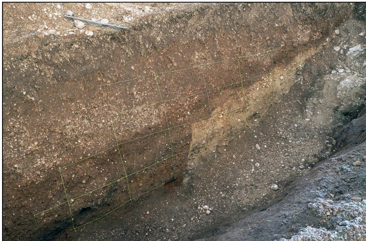
Figura 4. Trincea paleosismologica aperta attraverso la faglia di Norcia. Al centro è ben visibile la faglia subverticale che mette a contatto le ghiaie alluvionali di un conoide formatosi successivamente all'ultimo massimo glaciale (a destra) contro depositi limoso-sabbiosi di età olocenica e storica (sinistra). Le numerose trincee aperte sul sistema faglie di Norcia hanno permesso di identificare la fagliazione relativa al terremoto catastrofico del 14 Gennaio 1703 (Mw 6.9), una precedente riferibile al terremoto del 99 a.C., ed una nell'Età del Bronzo (Galli, Galadini e Calzoni 2005; Galli et al. 2018) (© Paolo Galli).
