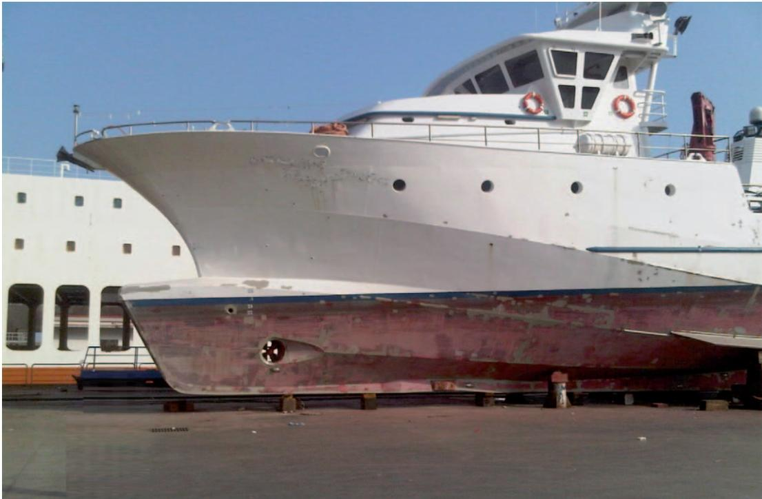
**Figura 14.7 - Integrazione ottimale del bulbo prodiero in uno scafo progettato *ex novo*.**
