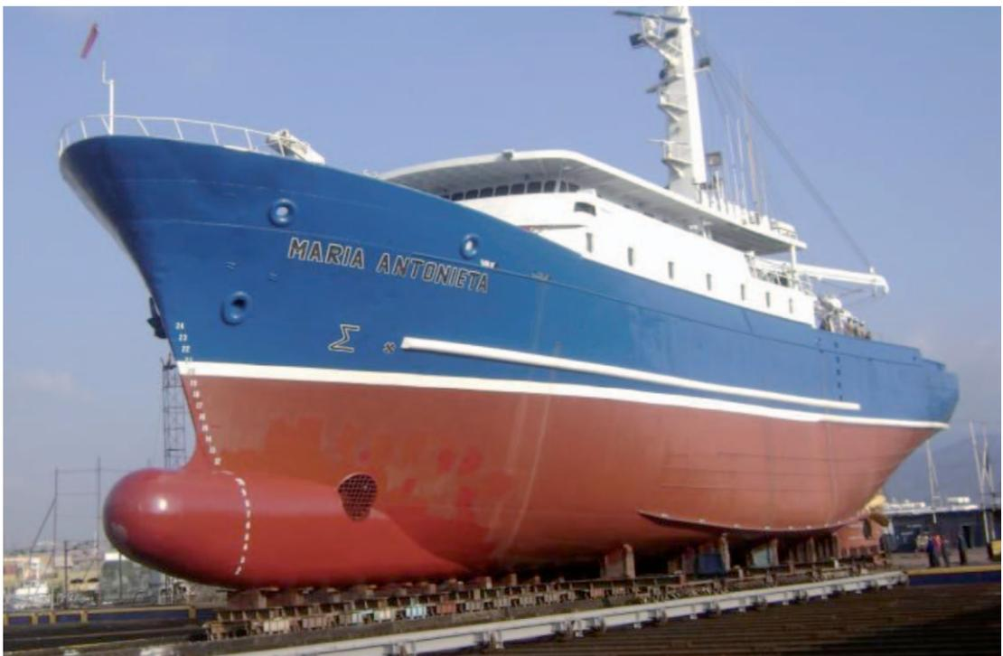
Figura 14.6 - Adattamento di uno scafo esistente con l'introduzione di un bulbo prodiero.
