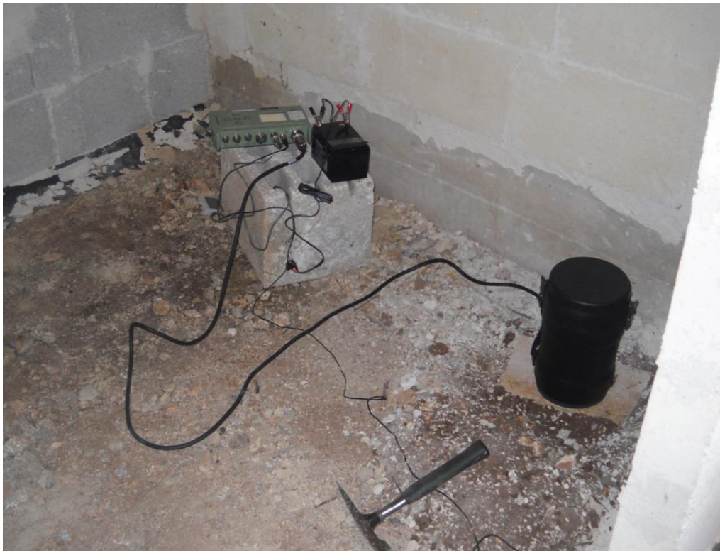
Fig. 6.3: Registrazione di rumore microsismico effettuata a Ceglie Messapica il 23/09/2010 all'interno del locale in cui è ospitata la stazione sismica.
