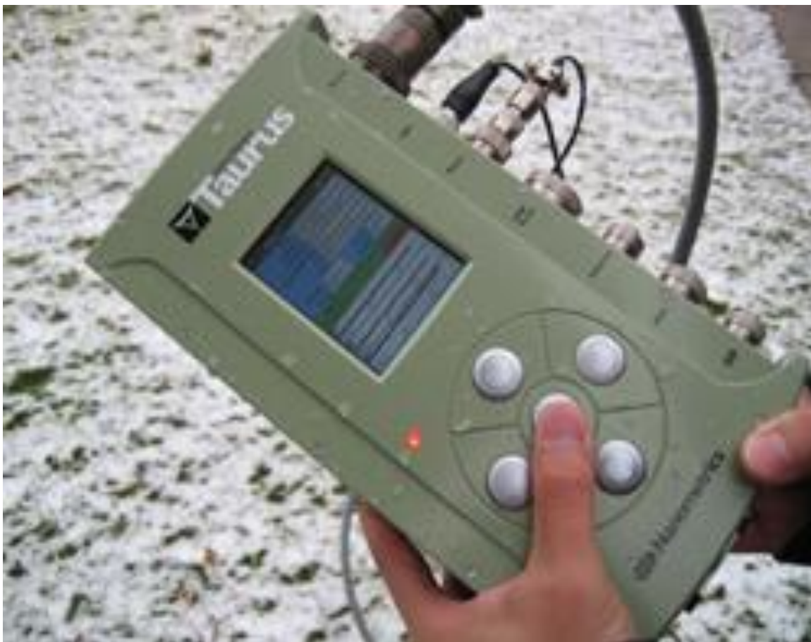
Fig. 6.2: Sistema di acquisizione Taurus della Nanometrics.
