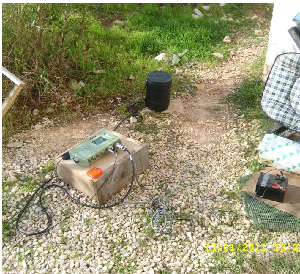
Fig. 6.5: Registrazione di rumore microsismico effettuata a Fasano il 13/01/2011 all'esterno della struttura in cui è ospitata la stazione sismica.
