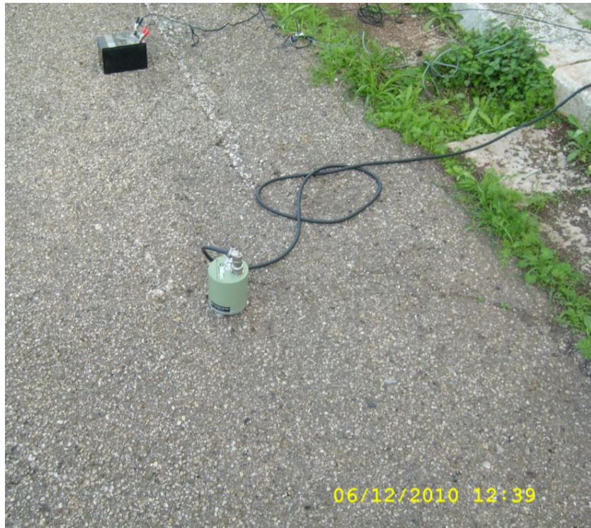
Fig. 6.6: Registrazione di rumore microsismico effettuata a Massafra il 06/12/2010 all'esterno della struttura in cui è ospitata la stazione sismica.
