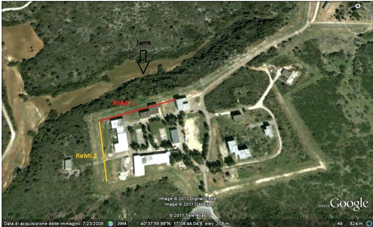
Fig. 6.21: Immagine satellitare dell'area della caserma "Ciaravolo" con indicazione dei profili 1 e 2 lungo cui è stato eseguito il ReMi e della lama (Google Earth).
