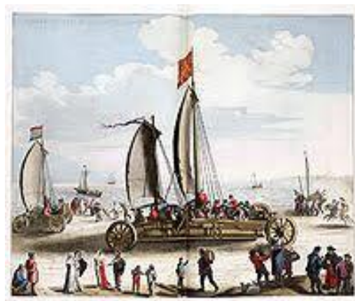
Figura 8. Carro impulsado por el viento. Alcanzaba cerca de 80 km/h y transportaba más de 25 personas
