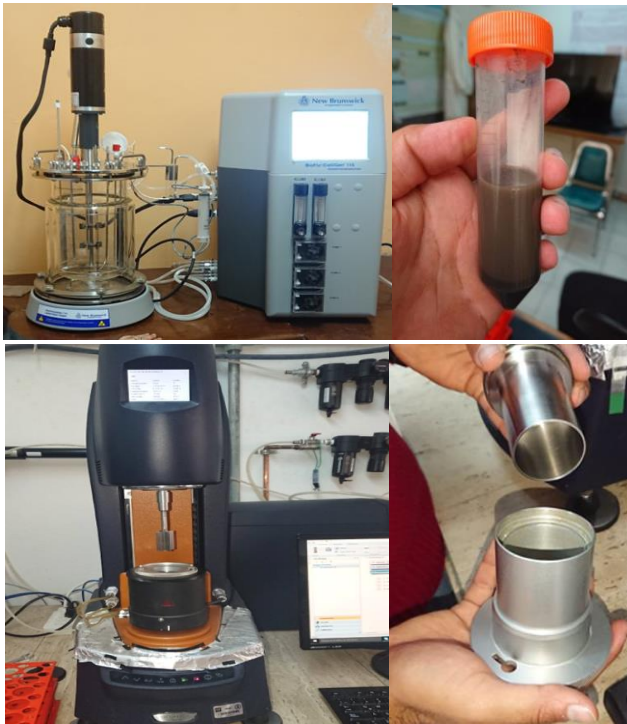
Figura 4. Biorreactor (superior izquierda), pulpa mineral (superior derecha), reómetro de esfuerzo controlado DHR3 (inferior izquierda) y sistema reométrico (inferior derecha)
