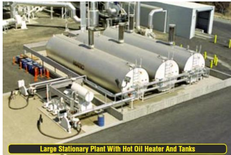
Figura 18. Sistema de tanques para calentamiento indirecto de cemento asfáltico (Heatec, 2003).
