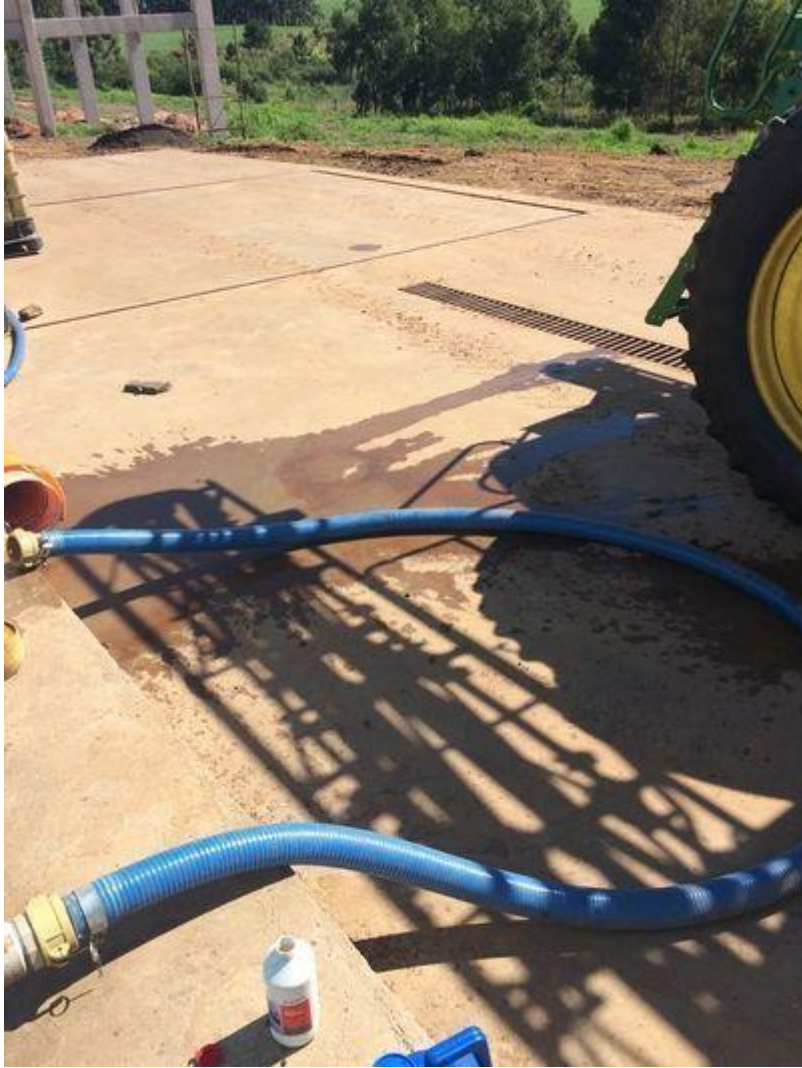
Figura 1. Coleta em pontos de abastecimento com piso de concreto
