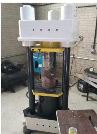
**Figura 37: Detalhe do processo de compactação (EKA-PKL40);**
