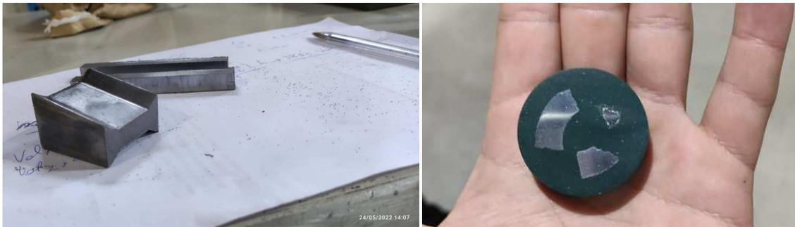
**Figura 46: (a) Polo e, (b) frações embutidas para análise de Somaloy® 5P, 3P e, 1P respectivamente em sentido horário (amostras embutidas, lixadas e polidas com pasta diamantada);**
