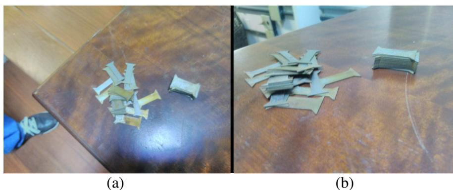
**Figura 30: Núcleo laminado desmontado extraído do processo eletro-erosão, em (a) vista de topo, em (b) vista em perspectiva;**
