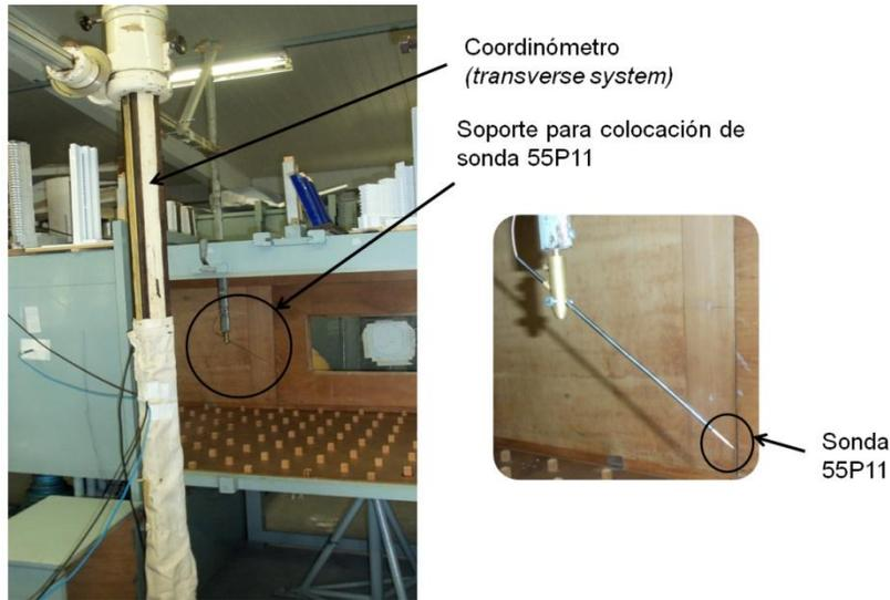
**Fig. 12 Colocación de sonda del CTA dentro del túnel de viento**
