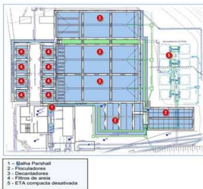
Figura8: Planta da estrutura da ETA da COMUSA
