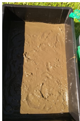
Figura 11: Secagem do lodo de ETA
