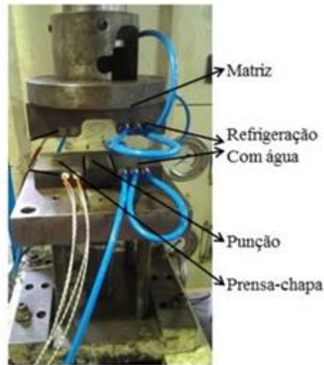
Figura 24 - Ferramental refrigerado instalado na prensa.
