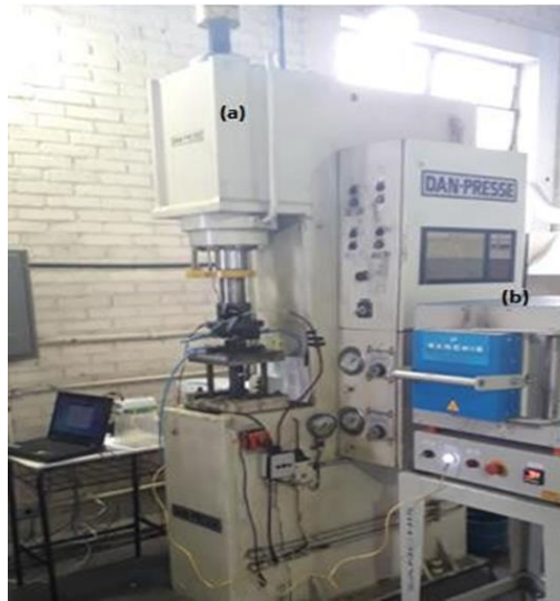
Figura 26 – Imagem do processo a) prensa Dan-Press b) Forno de aquecimento.
