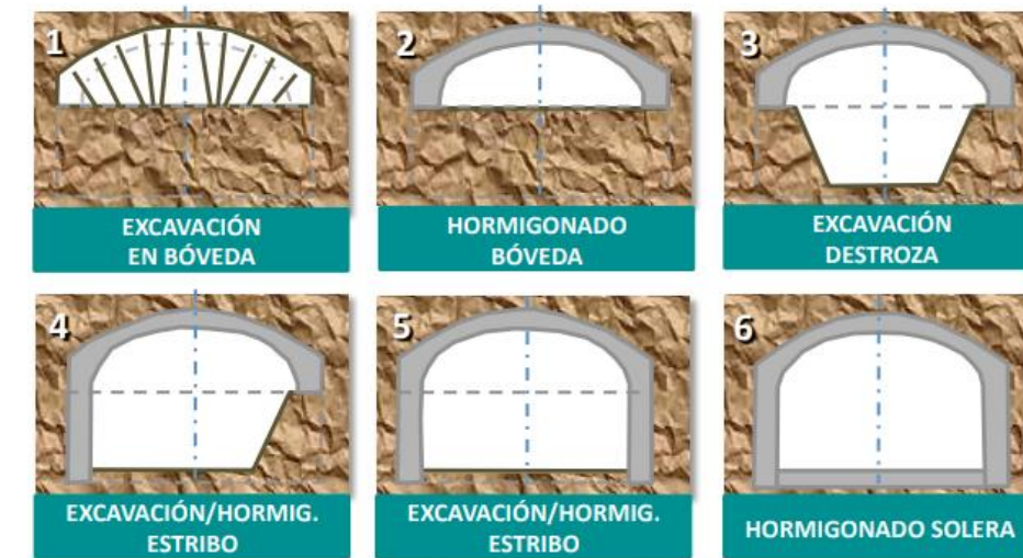
Ilustración 1. Ejecución de túnel por método belga.
