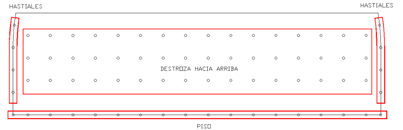
Ilustración 15. Esquema de barrenos en la destroza.
