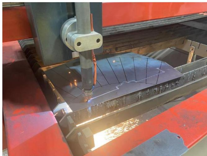
Figura 3: Corte con plasma de una pieza para la fabricación de los dispensadores.
