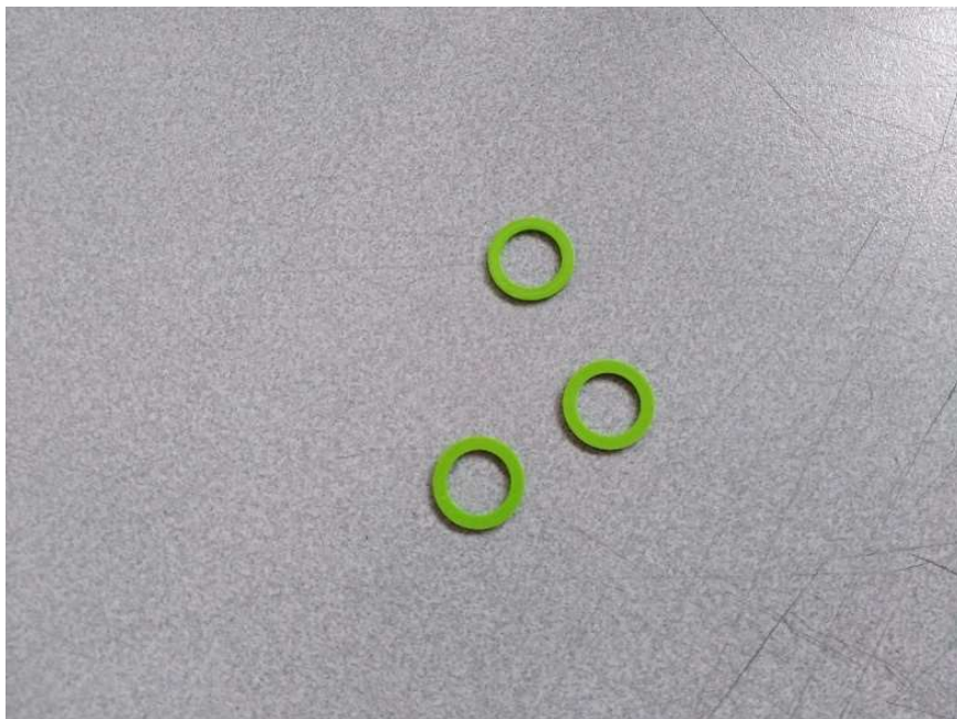
Figura 10. Arandelas de plástico de la botonera. Hechas en impresora 3D
