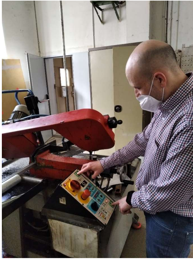
Figura 5. Corte de perfilería para bastidor
