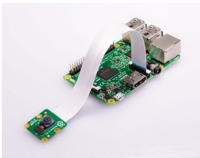
Figura 19. Raspberry Pi, con cámara, para el sistema de monitorización de las impresoras 3D.
