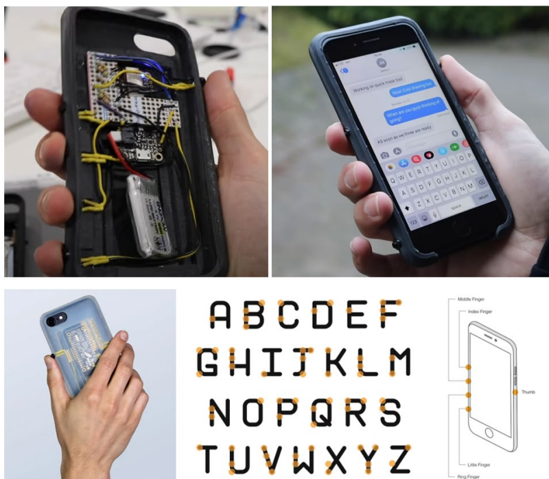
Figura 12. Funda para móvil para personas ciegas o personas que puedan utilizar una sola mano. Permite la escritura sin necesidad de tocar la pantalla táctil
