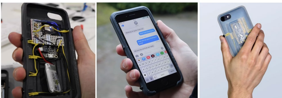
Figura 17. Producto de la Actividad 4. Ejemplo de montaje de la electrónica, desarrollo y funcionamiento de la funda para móviles, fabricada en 3D, para personas ciegas.
