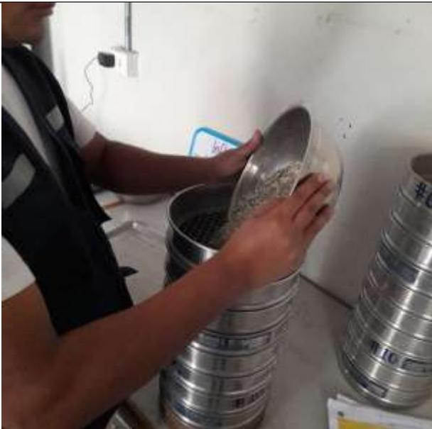
Ensayo granulométrico del agregado vaciado a tamices.
