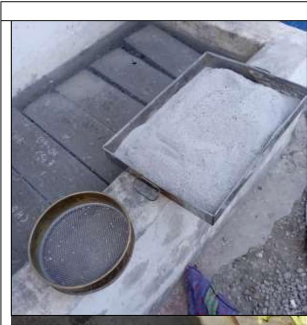
Almacenamiento de panca de maíz, secado a temperatura ambiente. Tamizado de ceniza de panca de yuca a través de la malla N°8.
