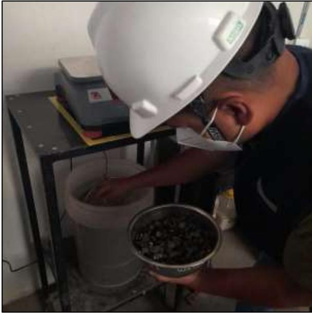
Ensayo del peso específico del agregado grueso.
