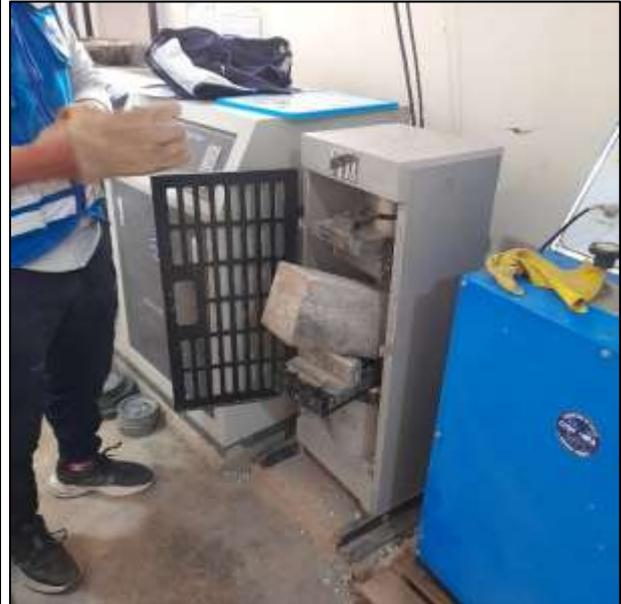
Ensayo de rotura de vigas a flexión.
