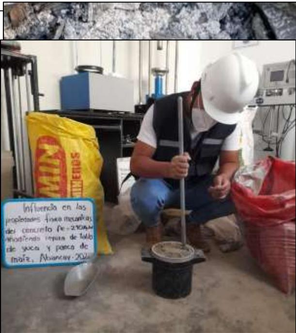
Ensayo de peso unitario suelto y compactado elaborado en laboratorio CONCHIPA.
