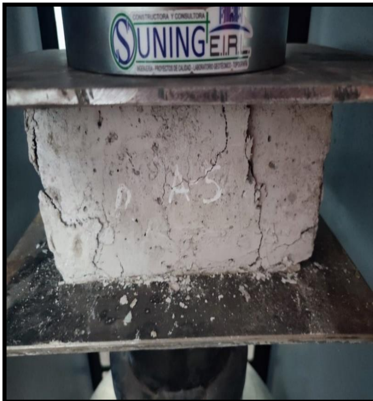
Fotografía 38. Vista de la forma de falla del adoquín con PET al 7 %.
