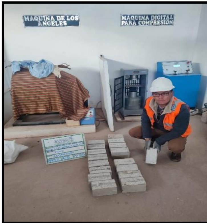
Fotografía 23. Preparación de los adoquines para el ensayo de compresión.
