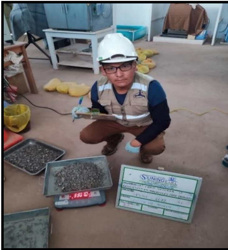
Fotografía 13. Pesaje del agregado grueso que será empleado en la mezcla.
