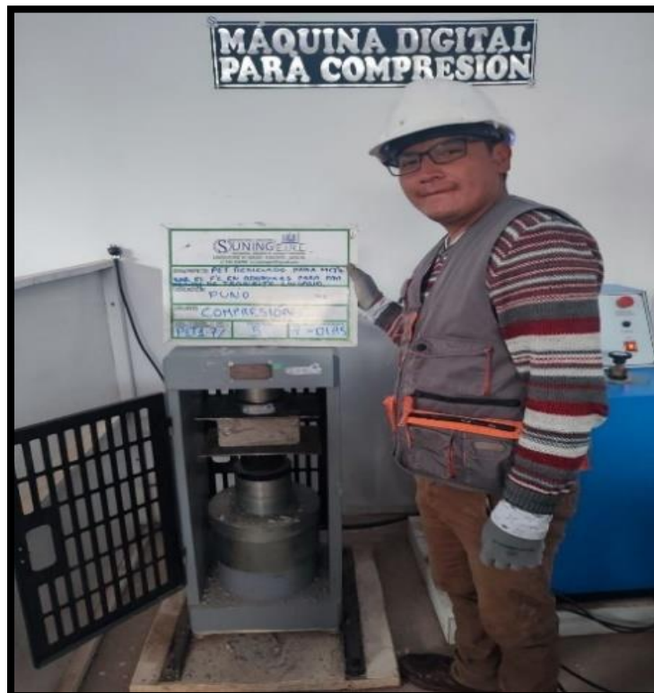
Fotografía 34. Rotura de adoquín de concreto con PET al 7 % a los 7 días.
