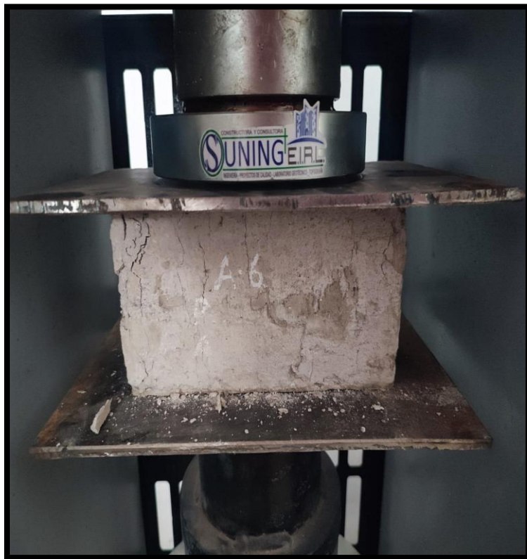
Fotografía 26. Vista de la rotura del adoquín patrón a los 7 días.
