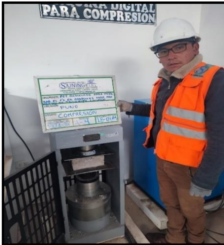
Fotografía 33. Rotura de adoquín de concreto con PET al 3 % a los 28 días.
