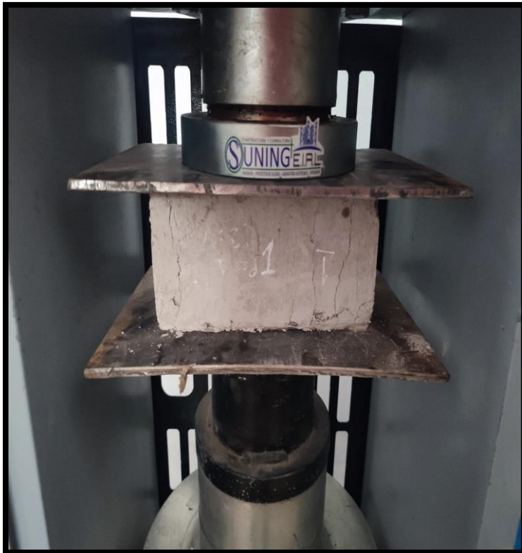
Fotografía 37. Vista de la forma de falla del adoquín con PET al 3 %.
