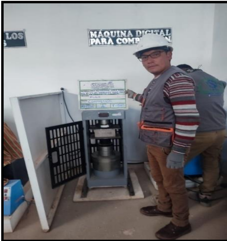
Fotografía 25. Vista de la rotura del adoquín patrón a los 7 días.
