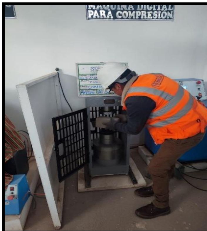
Fotografía 24. Vista de rotura del adoquín patrón.
