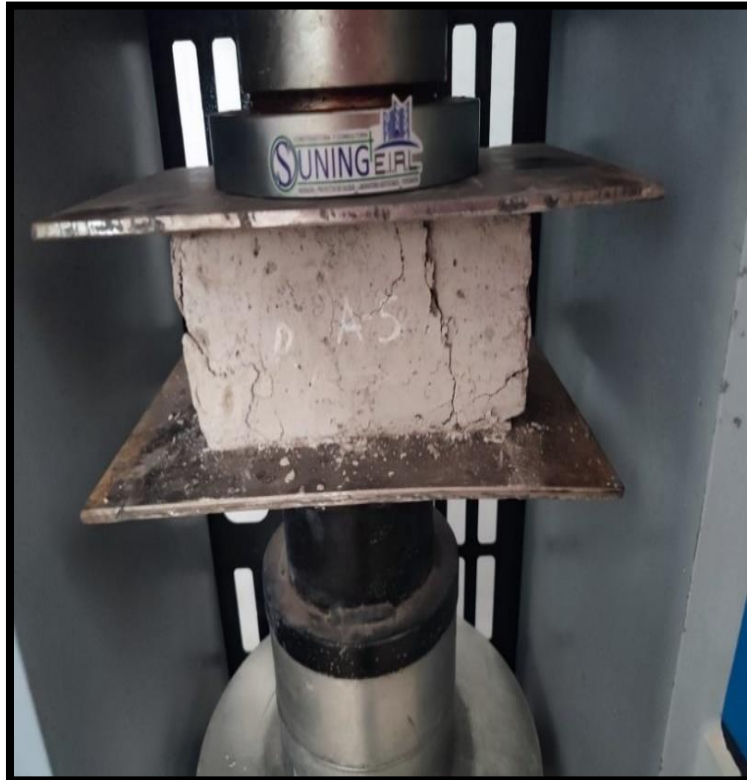
Fotografía 28. Vista de la rotura del adoquín patrón a los 14 días.
