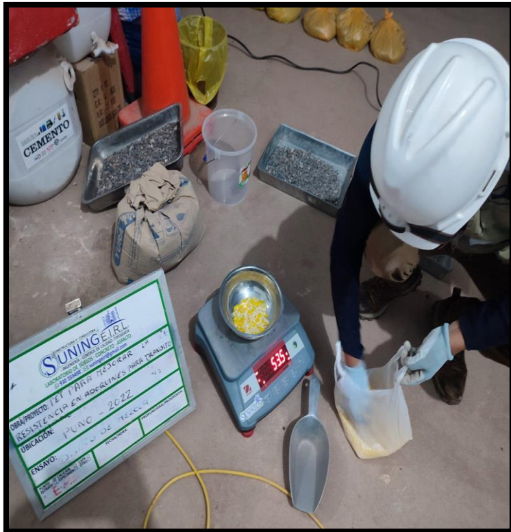
Fotografía 15. Pesaje del PET necesario para la mezcla del concreto.
