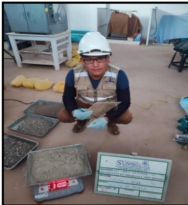
Fotografía 14. Pesaje del cemento necesario de cemento para la mezcla.
