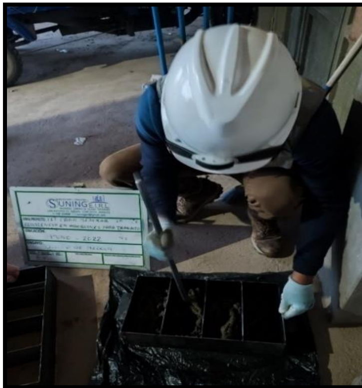
Fotografía 20. Proceso de compactado de las muestras del adoquín de concreto.
