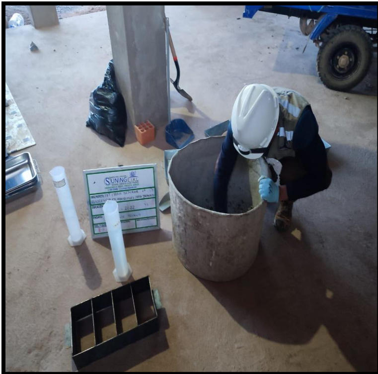
Fotografía 17. Limpieza del recipiente de mezclado,
