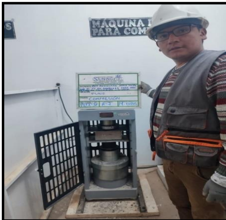
Fotografía 32. Rotura de adoquín de concreto con PET al 3 % a los 14 días.
