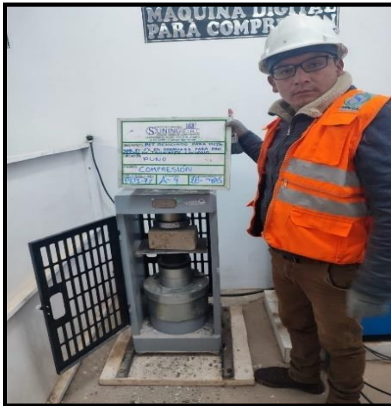
Fotografía 29. Vista de la rotura de adoquín patrón a los 28 días.
