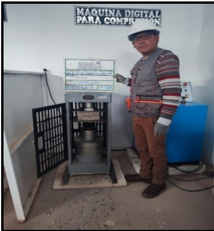
Fotografía 35. Rotura de adoquín de concreto con PET al 7 % a los 14 días.
