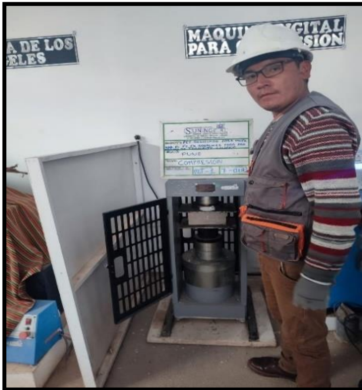
Fotografía 31. Rotura de adoquín de concreto con PET al 3 % a los 7 días.
