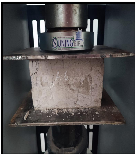
Figura 16: Vista de adoquín roturado. Fuente: Elaboración propia.
