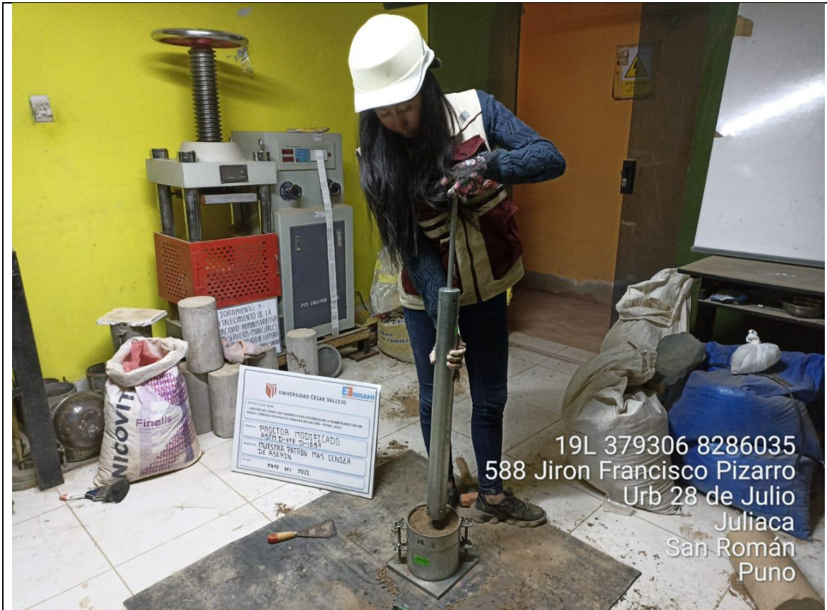
Figura 07. Ensayo de Proctor modificado
