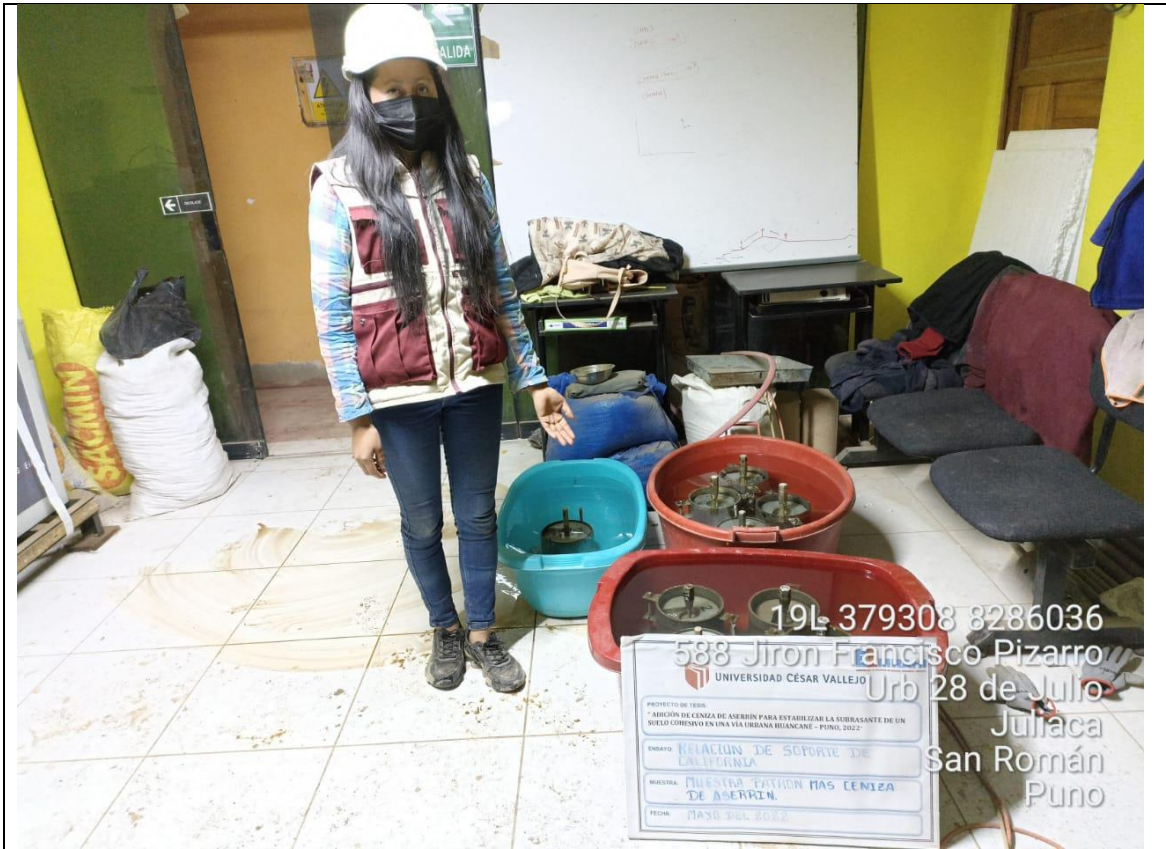
Figura 9. Ensayo de CBR (Muestras sumergidas en agua)
