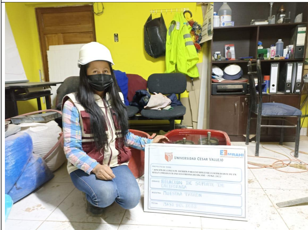
Figura 10. Ensayo de CBR (Muestras sumergidas en agua)
