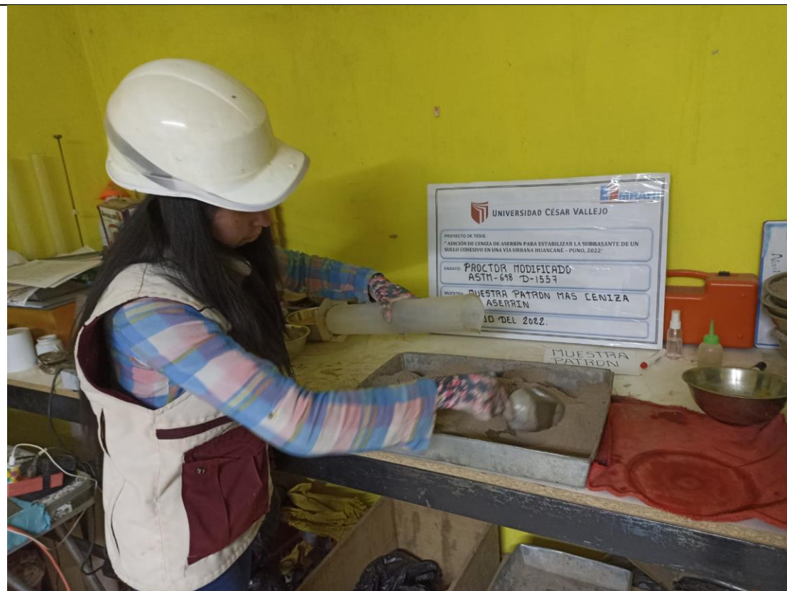
Figura 08. Ensayo de Proctor modificado (incorporación de agua)
