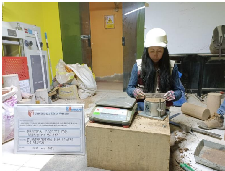
Figura 11. Ensayo de Proctor Modificado
