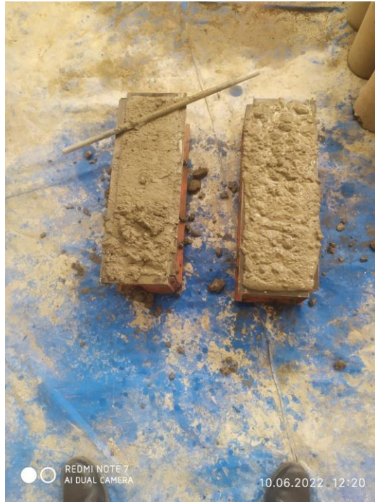
FOTOGRAFIA 15.- SE OBSERVA LA ELABORACION DE ESPECIMENES PRISMATICAS, COMO ESPECIMENES PATRON, Y CON ADICION DE CAUCHO AL 5%, 7% Y 9%
