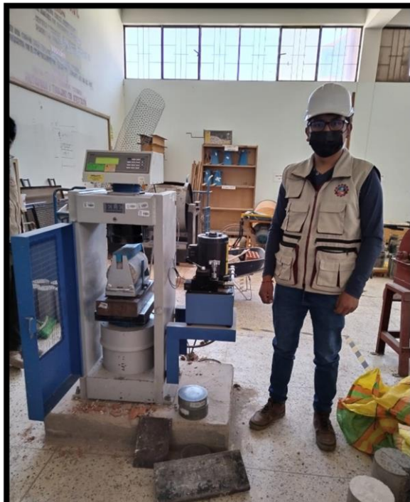
FOTOGRAFIA 20.- SE OBSERVA EL ENSAYO DE TRACCION INDIRECTA
