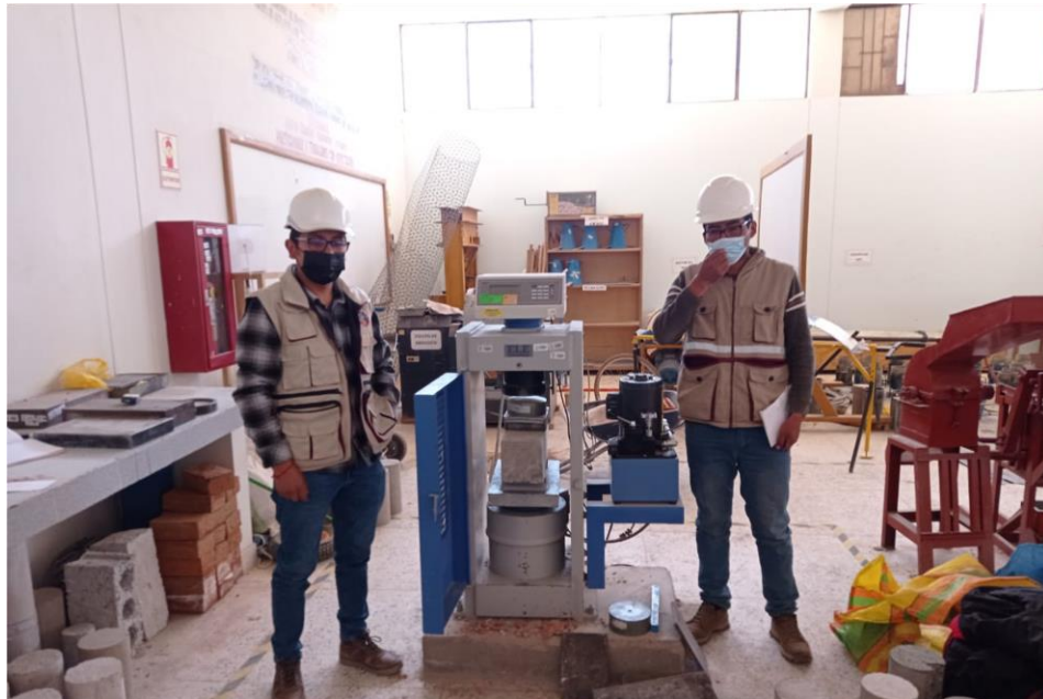
FOTOGRAFIA 24.- SE OBSERVA EL ENSAYO DE FLEXION EN ESPECIMENES PRISMATICAS
