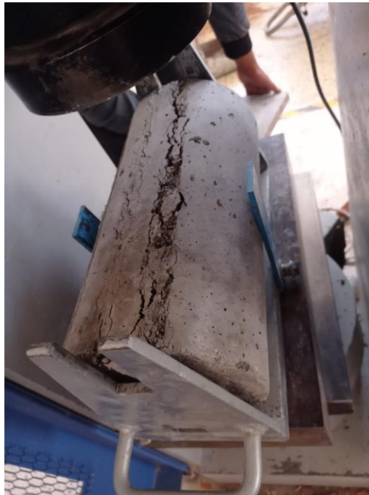
FOTOGRAFIA 22.- SE OBSERVA EL ENSAYO DE TRACCION INDIRECTA
