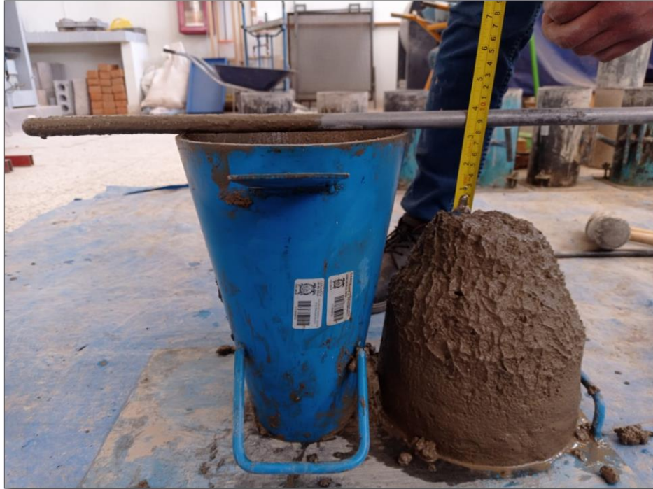
FOTOGRAFIA 09.- SE OBSERVA LA OBTENCION DEL ASENTAMIENTO DEL CONCRETO, DONDE SE OBTIENE UNA CONSISTENCIA PLASTICA SEGÚN ESPECIFICACIONES TECNICAS
