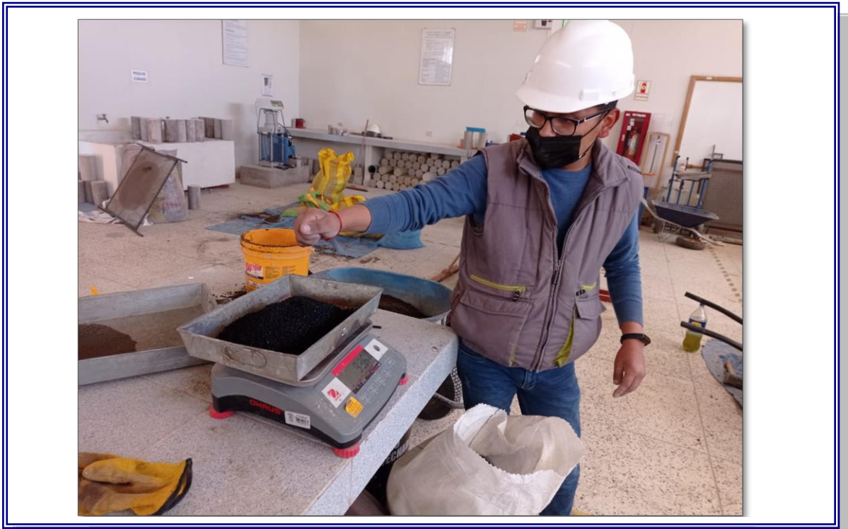
FOTOGRAFIA 06.- SE OBSERVA EL PESADO DEL CAUCHO RECICLADO SEGÚN EL DISEÑO DE MEZCLAS PARA LA ELABORACION DE ESPECIMENES
