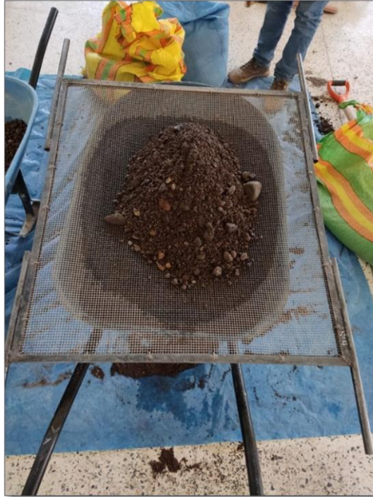
FOTOGRAFIA 03.- SE OBSERVA EL TAMIZADO DEL MATERIAL PARA SEPARAR EL AGREGADO FINO Y GRIESO
