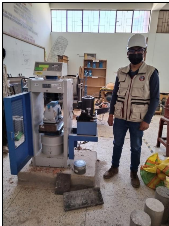
Figura 19. Esfuerzo a tracción indirecta del espécimen
