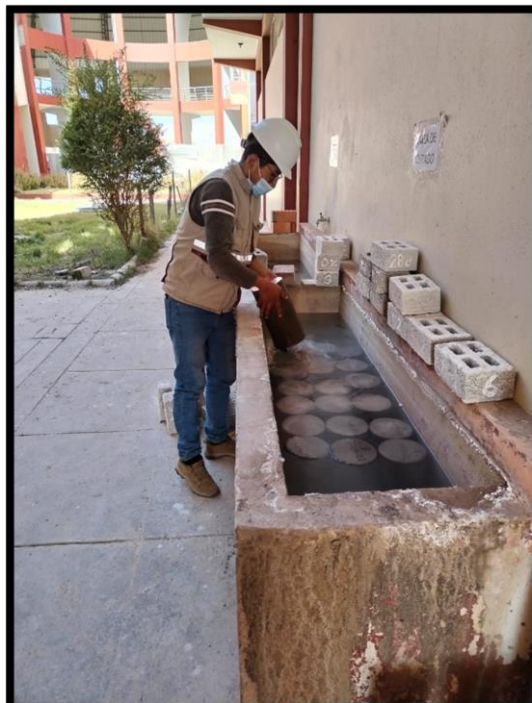
FOTOGRAFIA 16.- SE OBSERVA EL CURADO DE ESPECIMENES DE CONCRETO
