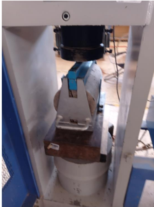
FOTOGRAFIA 21.- SE OBSERVA EL ENSAYO DE TRACCION INDIRECTA
