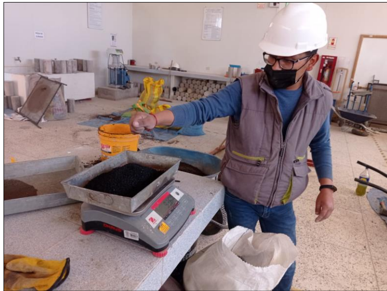
Figura 13. Cantidad determinada de caucho reciclado granulado.
