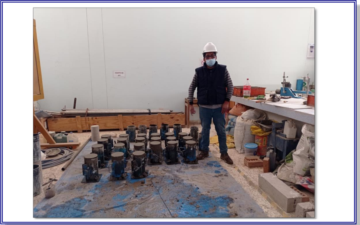
FOTOGRAFIA 13.- SE OBSERVA ESPECIMENES CILINDRICOS PATRON, Y CON ADICION DE CAUCHO AL 5%, 7% Y 9%
