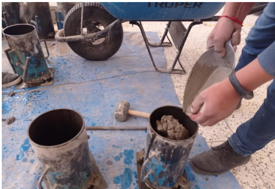
FOTOGRAFIA 10.- SE OBSERVA LA ELABORACION DE ESPECIMENES CILINDRICOS, COMO ESPECIMENES PATRON, Y CON ADICION DE CAUCHO AL 5%, 7% Y 9%
