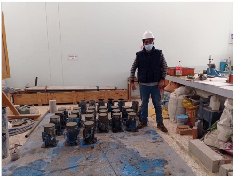
Figura 16. Elaboración de especímenes de concreto.
