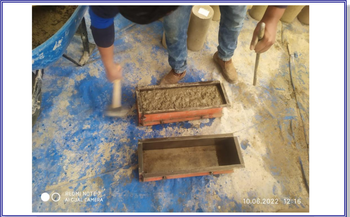
FOTOGRAFIA 14.- SE OBSERVA LA ELABORACION DE ESPECIMENES PRISMATICAS, COMO ESPECIMENES PATRON, Y CON ADICION DE CAUCHO AL 5%, 7% Y 9%
