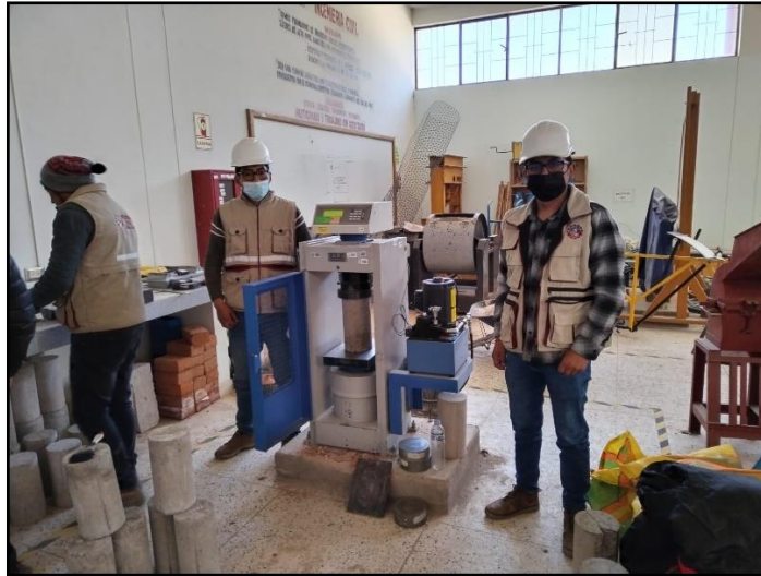
Figura 18. Esfuerzo a la compresión de especímenes
