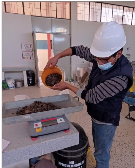
FOTOGRAFIA 04.- SE OBSERVA EL PESADO DEL AGREGADO SEGÚN EL DISEÑO DE MEZCLAS PARA LA ELABORACION DE ESPECIMENES
