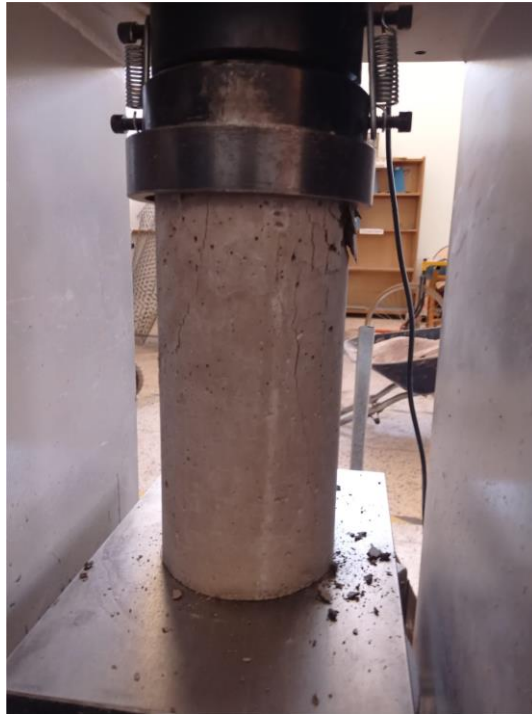
FOTOGRAFIA 19.- SE OBSERVA EL ENSAYO DE COMPRESION
