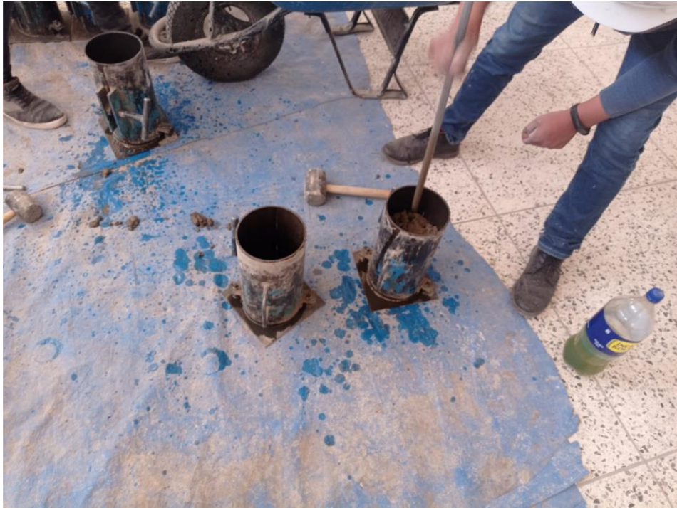
FOTOGRAFIA 11.- SE OBSERVA LA ELABORACION DE ESPECIMENES CILINDRICOS, COMO ESPECIMENES PATRON, Y CON ADICION DE CAUCHO AL 5%, 7% Y 9%
