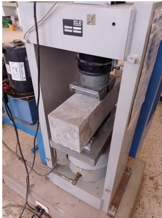
FOTOGRAFIA 23.- SE OBSERVA EL ENSAYO DE FLEXION EN ESPECIMENES PRISMATICAS
