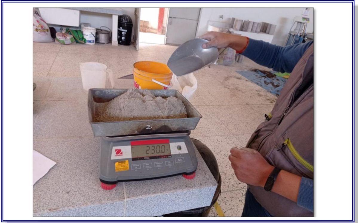
FOTOGRAFIA 05.- SE OBSERVA EL PESADO DEL CEMENTO SEGÚN EL DISEÑO DE MEZCLAS PARA LA ELABORACION DE ESPECIMENES
