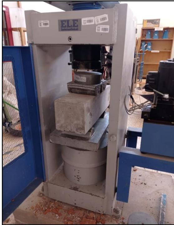
Figura 20. Esfuerzo a flexión del espécimen prismático
