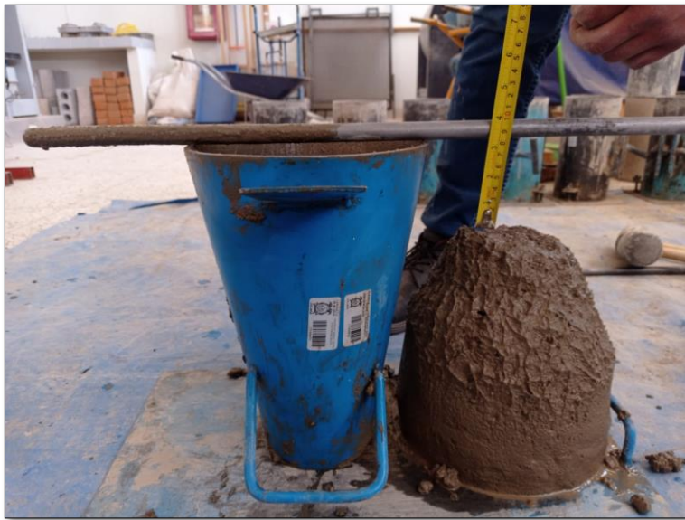
Figura 15. Asentamiento del concreto (Slump)
