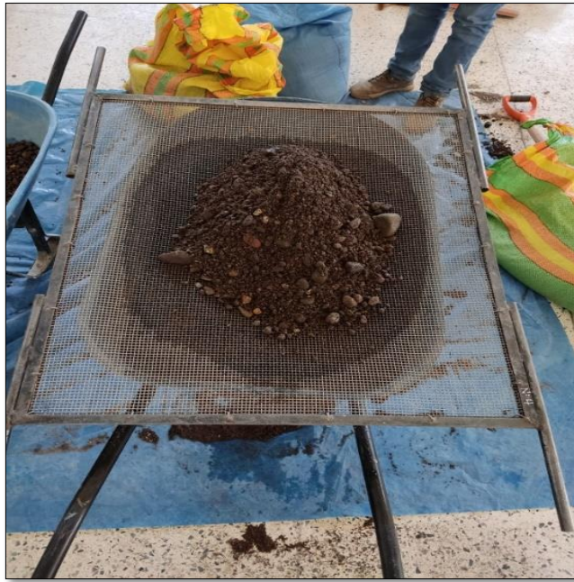
Figura 9. Tamizado del agregado.
