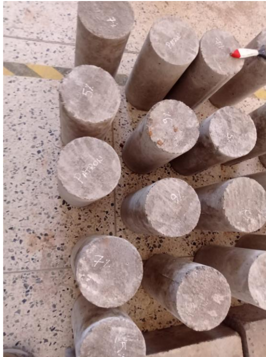
FOTOGRAFIA 17.- SE OBSERVA EL SECADO DE ESPECIMENES DE CONCRETO PARA EL RESPECTIVO ENSAYO DE COMPRESION, TRACCION INDIRECTA Y FLEXION.
