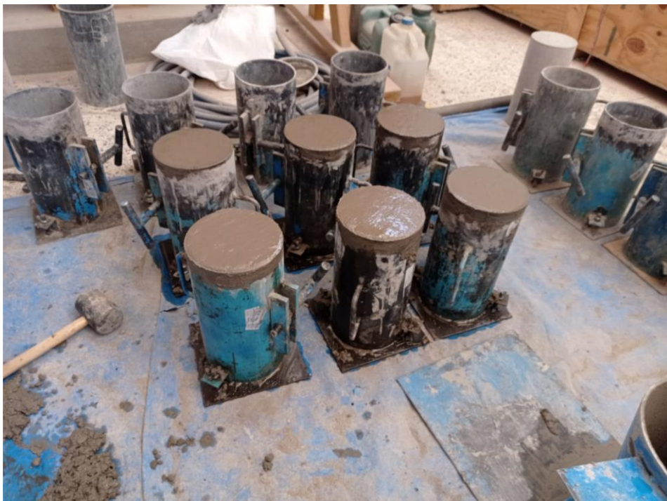
FOTOGRAFIA 12.- SE OBSERVA LA ELABORACION DE ESPECIMENES CILINDRICOS PATRON
