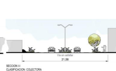
SECCIÓN H CLASIFICACION: COLECTORA NOMBRE: AV. EL DORADO TRAMO: AV. LAS LOMAS DE CARABAYLLO – CALLE EL PROGRESO
