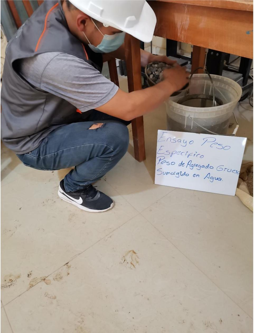
Figura 13 Ensayo de peso específico, del agregado grueso- Fuente Propia.
