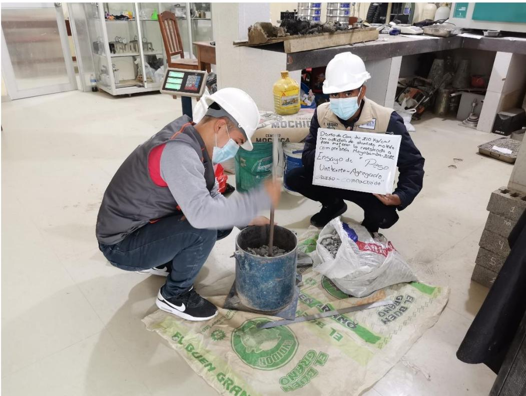
Figura 17 Ensayo peso unitario compactado del agregado grueso- Fuente Propia.
