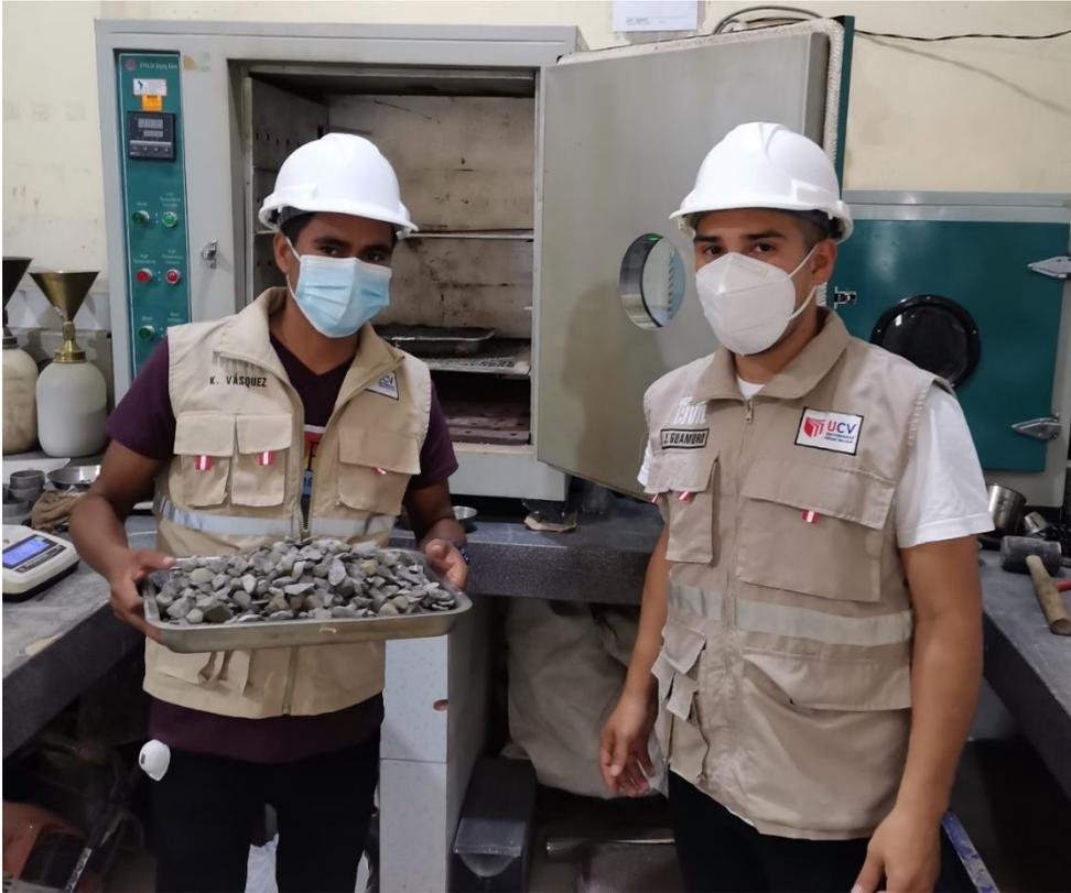
Figura 5 Secado de muestra del agregado grueso para los ensayos de Granulometría y peso específico- Fuente Propia.
