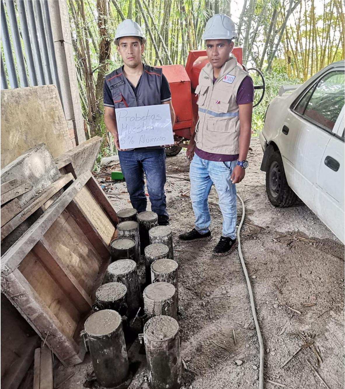
Figura 22 Probetas, con adición al 5% de aluminio molido- Fuente Propia.
