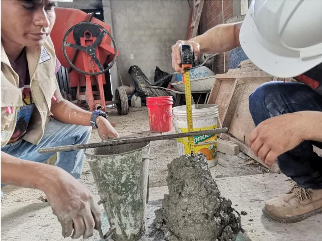
Figura 18 Ensayo de Slump, 3"- Fuente Propia.
