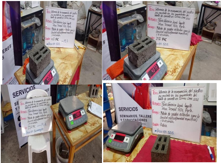
Ensayo de Absorción en muestra PATRÓN, 25%, 40 y 80% DE PVC.
