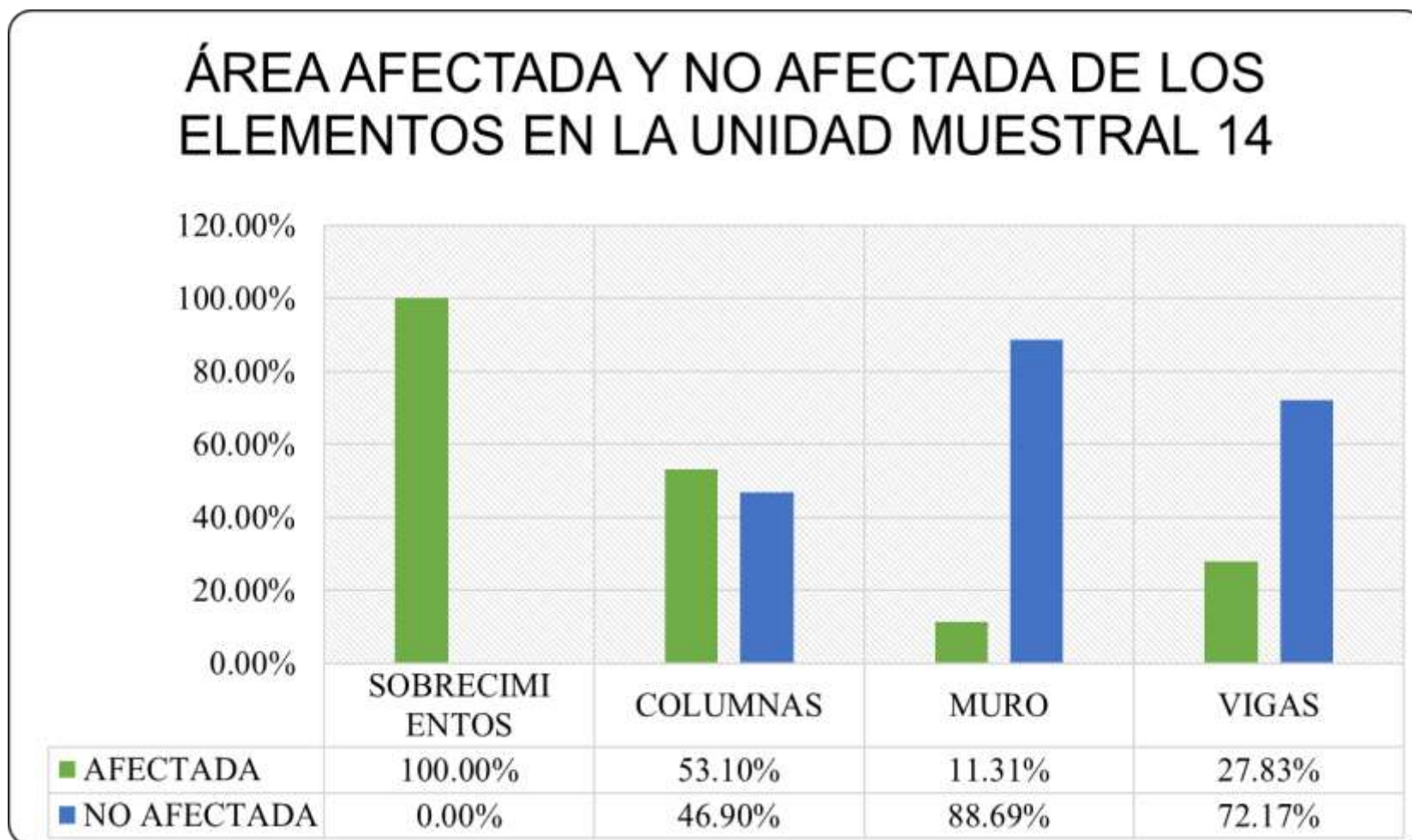
Gráfico 55: Porcentaje de Área afectada y no afectada de los Elementos en la Unidad Muestral 14.
