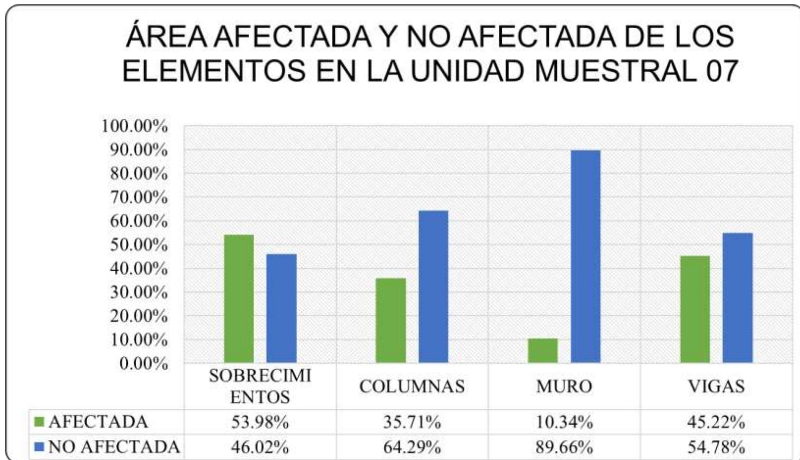
Gráfico 27: Porcentaje de Área afectada y no afectada de los Elementos en la Unidad Muestral 07.
