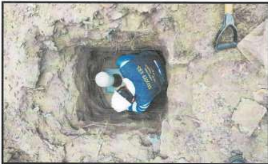
VISTA DE ENSAYO DE DENSIDAD EN CALICATA N° 3
