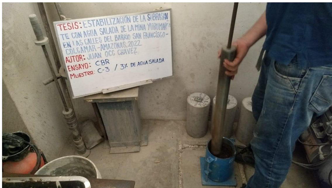
Fotografía 11. Ensayos de compactación para determinar la máxima densidad seca y el óptimo contenido de humedad, mediante el ensayo del Proctor modificado
