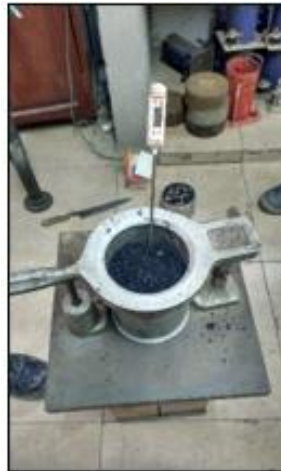
Figura N° 36: Compactación de mezcla asfáltica
