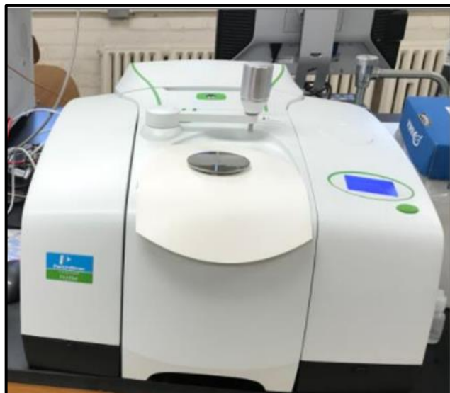
Figura 32: Análisis por espectrofotómetro para obtención de tipo de plástico.
