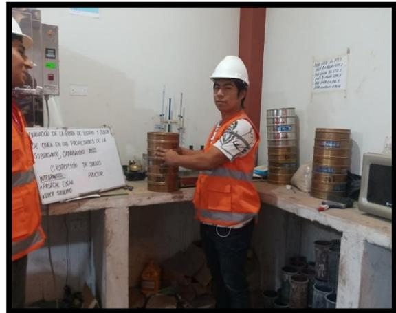
**FIGURA 7:** análisis granulométrico pasando por la malla número 200.
