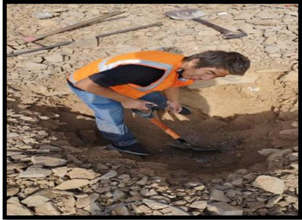
**IMAGEN 2:** se observa la obtención de la Muestra de suelo.
