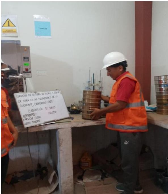
Figura N° 16: Ensayo de análisis granulométrico
