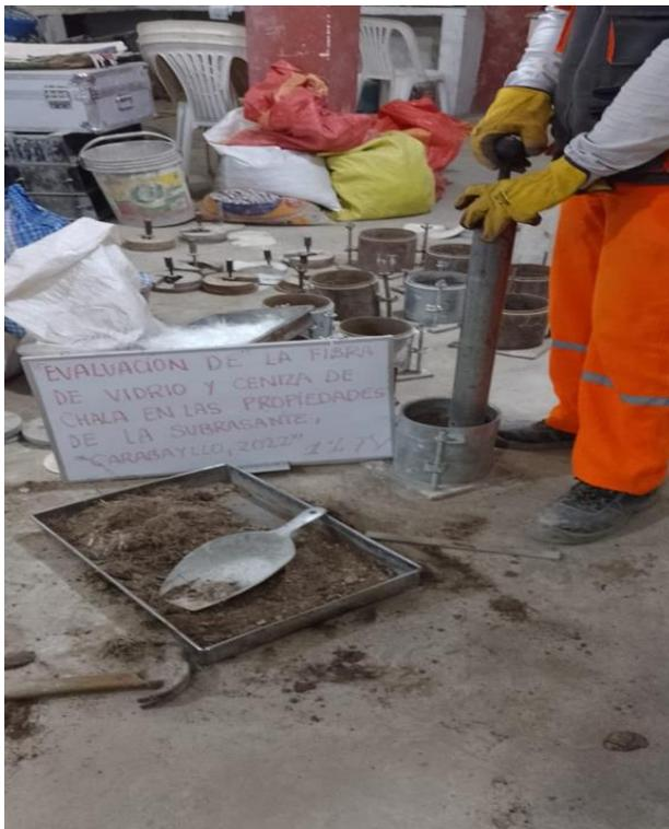
Figura 26. Prueba de resistencia suelos (CBR)
