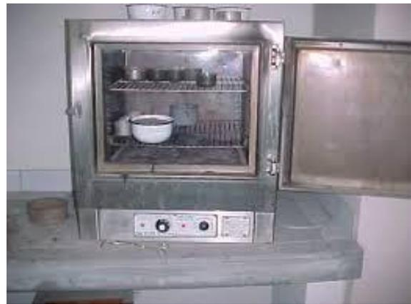
Figura 21. Prueba de contenido de humedad
