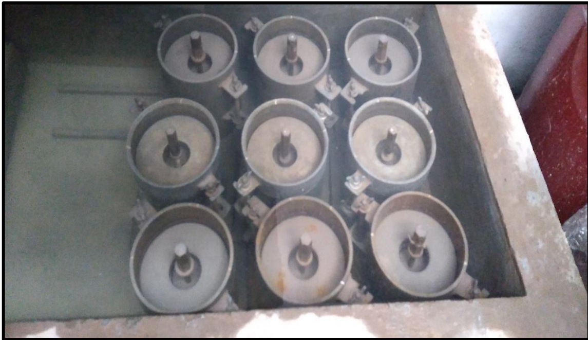
Fuente: muestras sumergidas del CBR para medir la expansión en el laboratorio FAMI.
