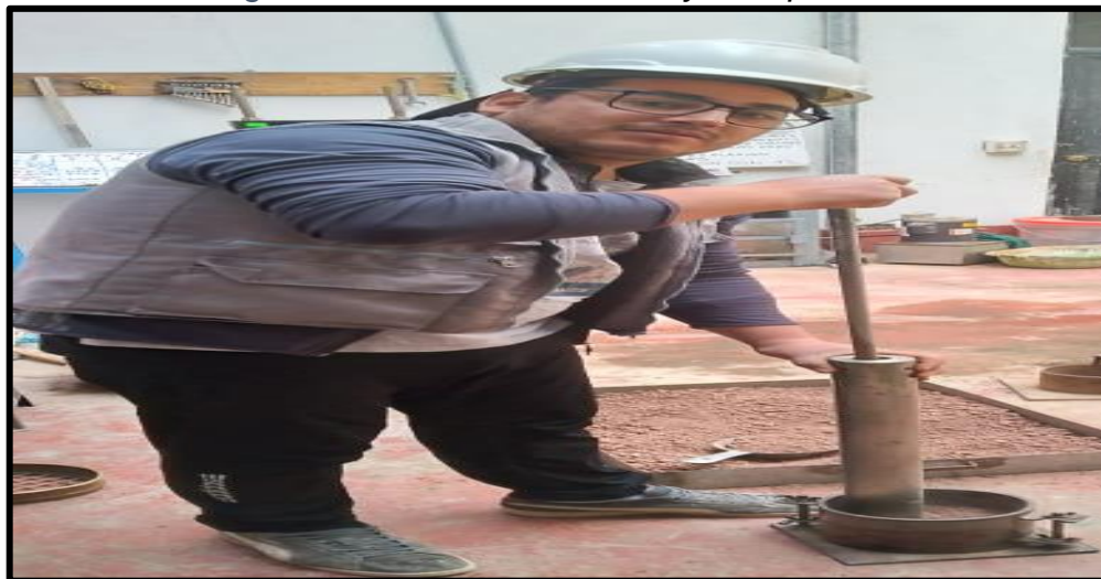
Figura 29: Realizando el ensayo del proctor.
