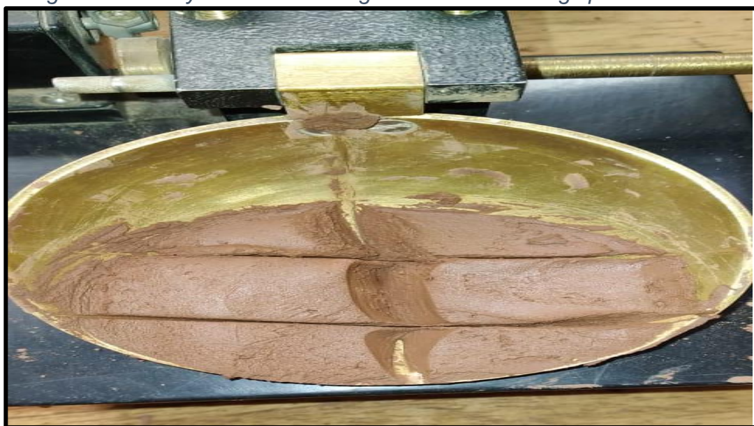
Figura 25: Ensayo Cuchara Casagrande números de golpes saturación.
