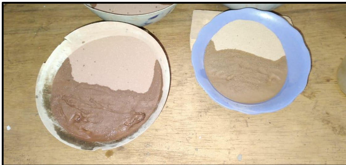
Figura 24: Realizando el ensayo de L.L y L.P.
