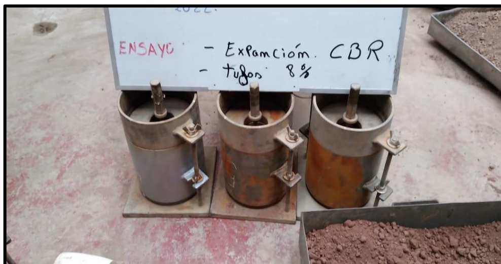
Figura 31. Imagen de los moldes antes de sumergirlos para el CBR.
