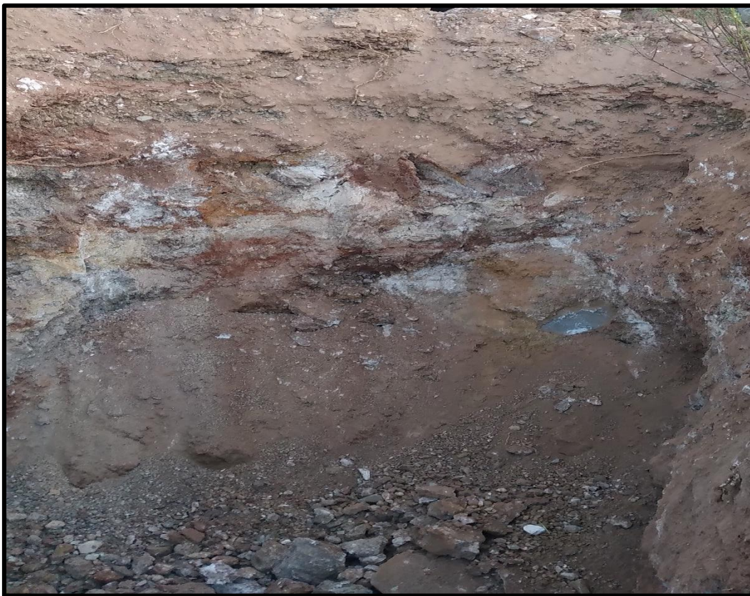
Figura 6: Perfil de una calicata.
