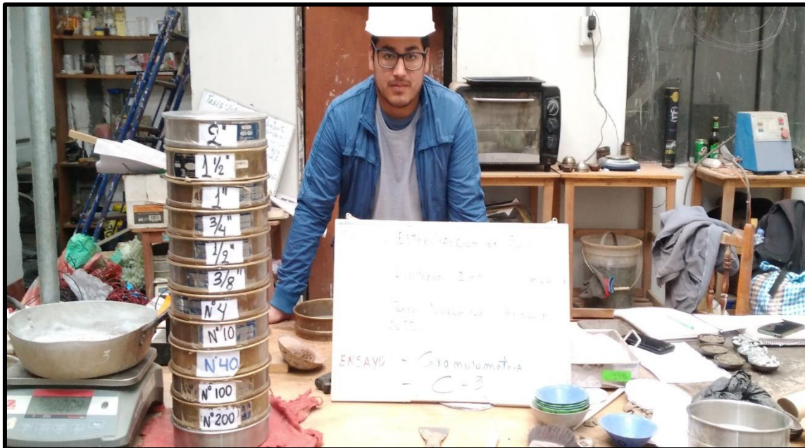
DESCRIPCION: Ensayo de granulometría de la 03 calicata.
