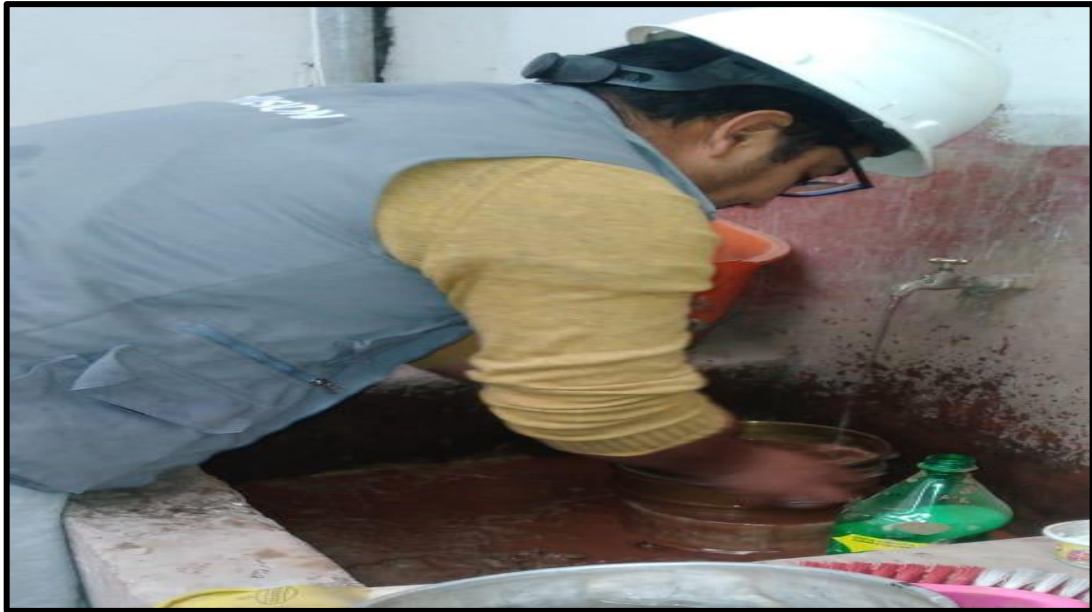
DESCRIPCION: Proceso de lavado de muestra de la calicata C-1, C-2 Y C3. Tabla 20. Ensayo de granulometría.
