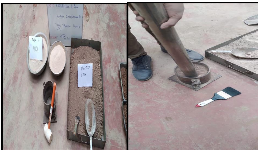
Figura 8: Proctor para encontrar la humedad óptima.
