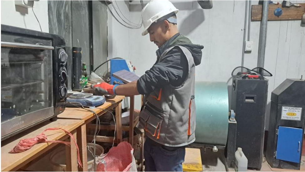
Figura 03: pesado de las muestras para determinar el porcentaje de humedad.
