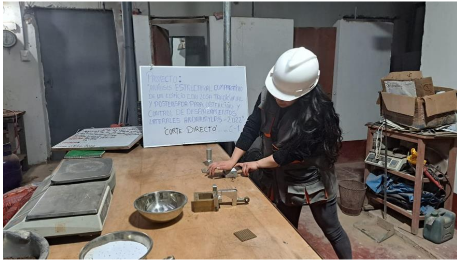
Figura 03: Se presiona la muestra de suelos en el muestreador para compactarla.
