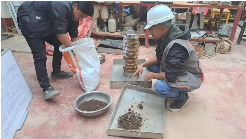
Figura 03: División de muestra de suelo para realizar el análisis granulométrico por medio del tamizado.
