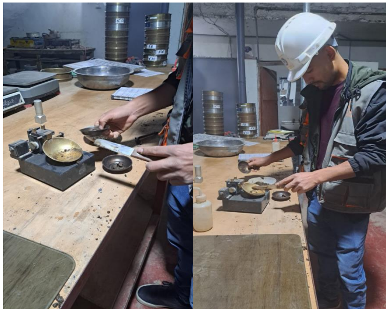
Figura 03: Se realizo el ensayo en las cuales la ranura de la muestra se cerro con 38 golpes, se toma una pequeña muestra para poder pesarla.
