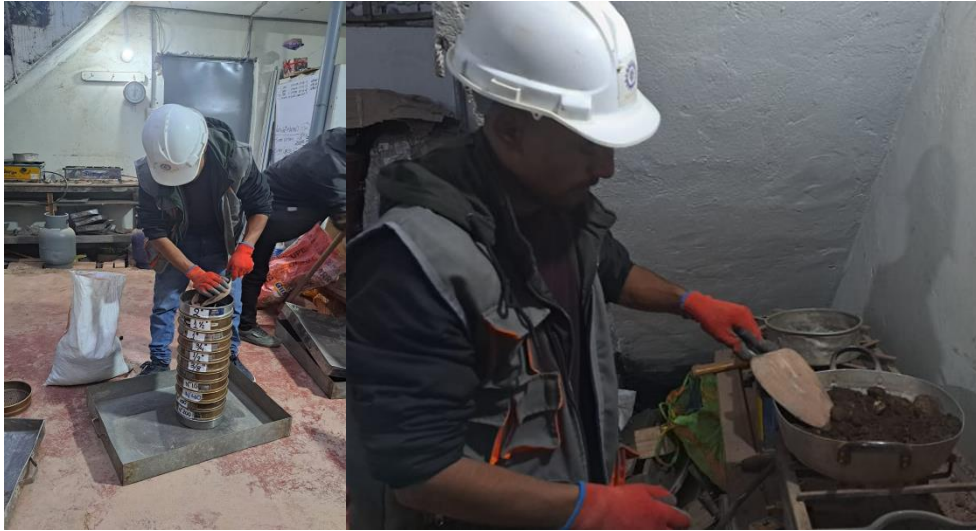
Figura 03: Secado de muestra de suelo para ensayo de análisis granulométrico.
