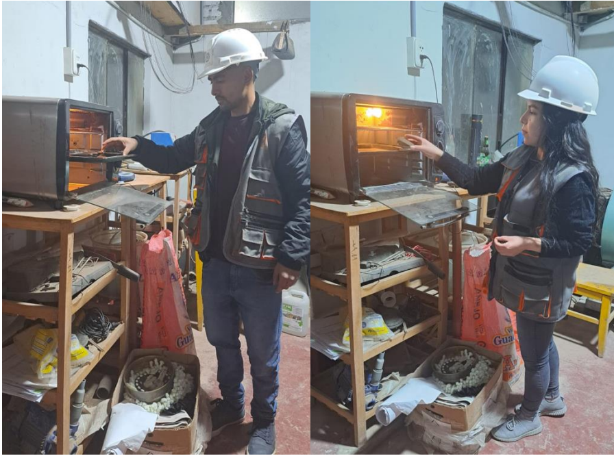
Figura 03: Se procede al pesado de la tara sola y después con la muestra para luego llevarla al horno de secado y posteriormente sacar su porcentaje de humedad.
