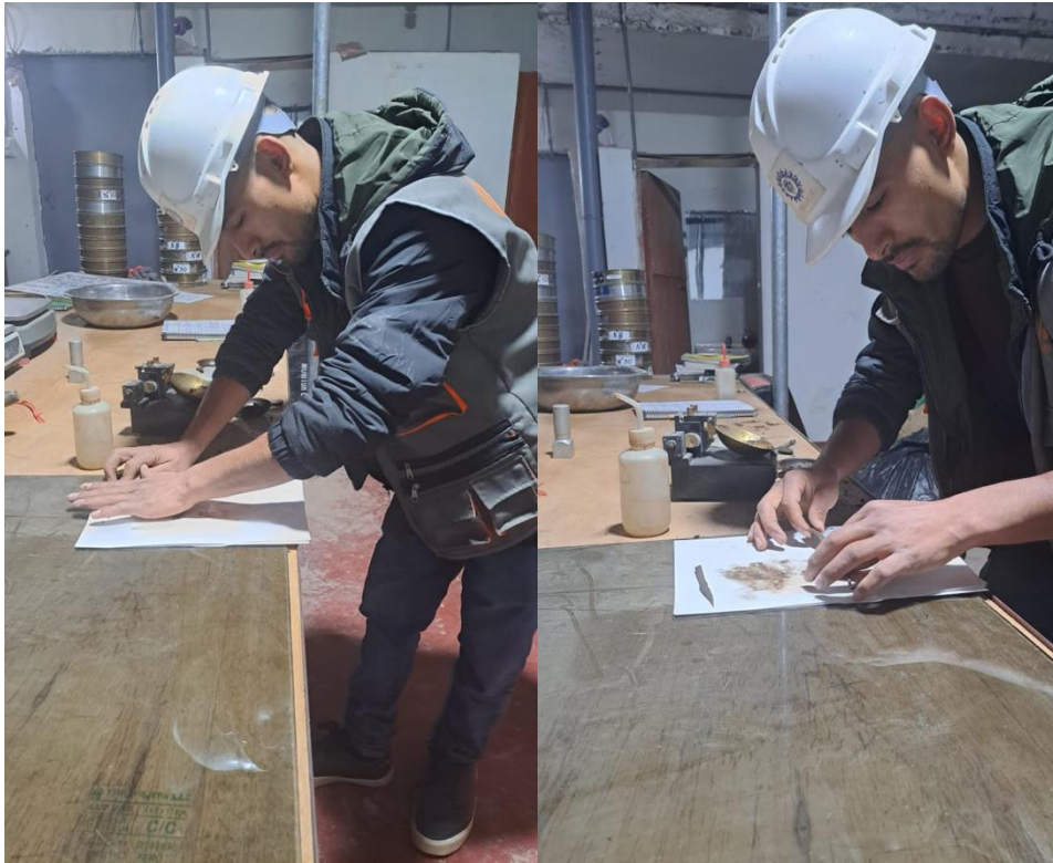
Figura 03: Ensayo de limite plástico enrollado de suelo.
