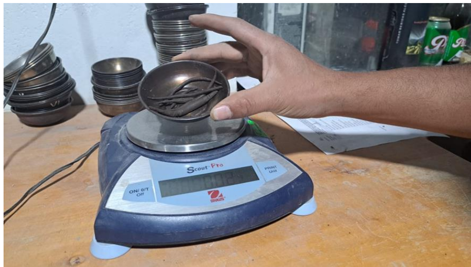
Figura 03: Pesado de la muestra de suelo.
