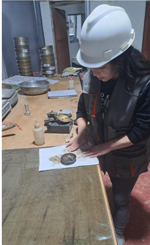
Figura 03: Enrollado del suelo para ensayo de limite plástico.
