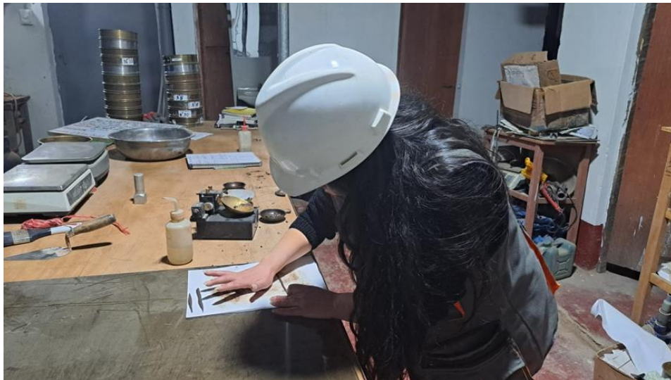
Figura 03: Ensayo de limite plástico enrollado de suelo.
