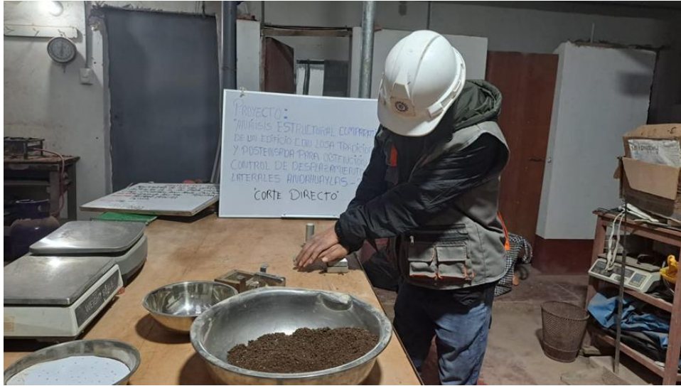
Figura 03: Ensayo de corte directo, se procede a colocar al muestreador una porción de suelo para luego presionar y compactar la muestra.
