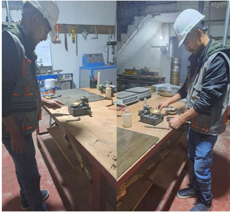
Figura 03: Se obtiene la muestra que paso por el tamiz #40 para posteriormente humedecerla y colocarla en la copa casa grande
