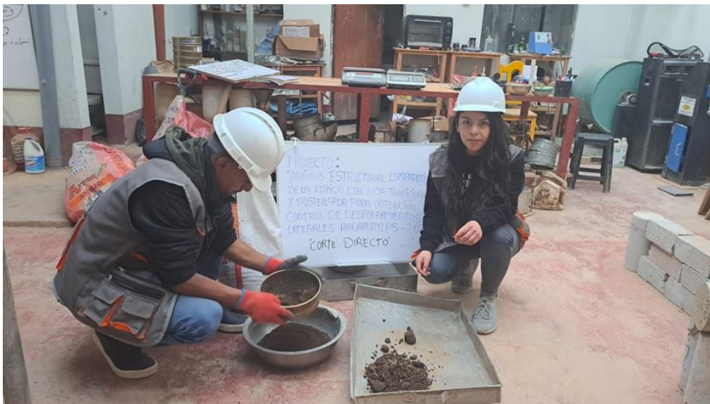
Figura 03: tamizado de muestra seca de suelo para ensayo de corte directo.
