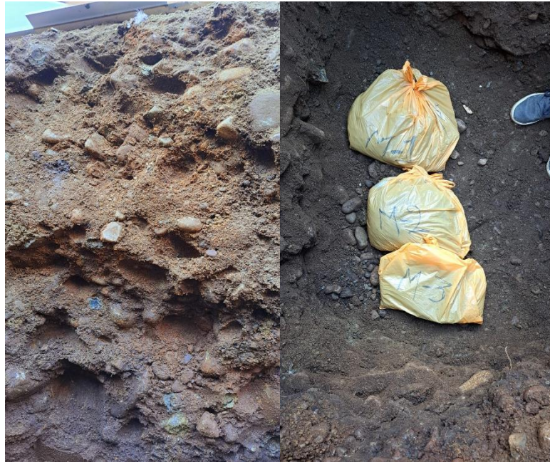
Figura 07: Calicata c-1 profundidad 3 metros como lo especifica la normativa muestra-1; muestra-2 y muestra-3.
