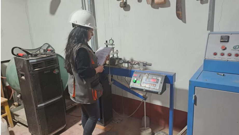
Figura 03: Se toma nota de los datos obtenidos en la placa de transferencia de corte, se toman las medidas del dinamómetro a los 5 y 10 segundos y cada 20 segundos posteriormente.
