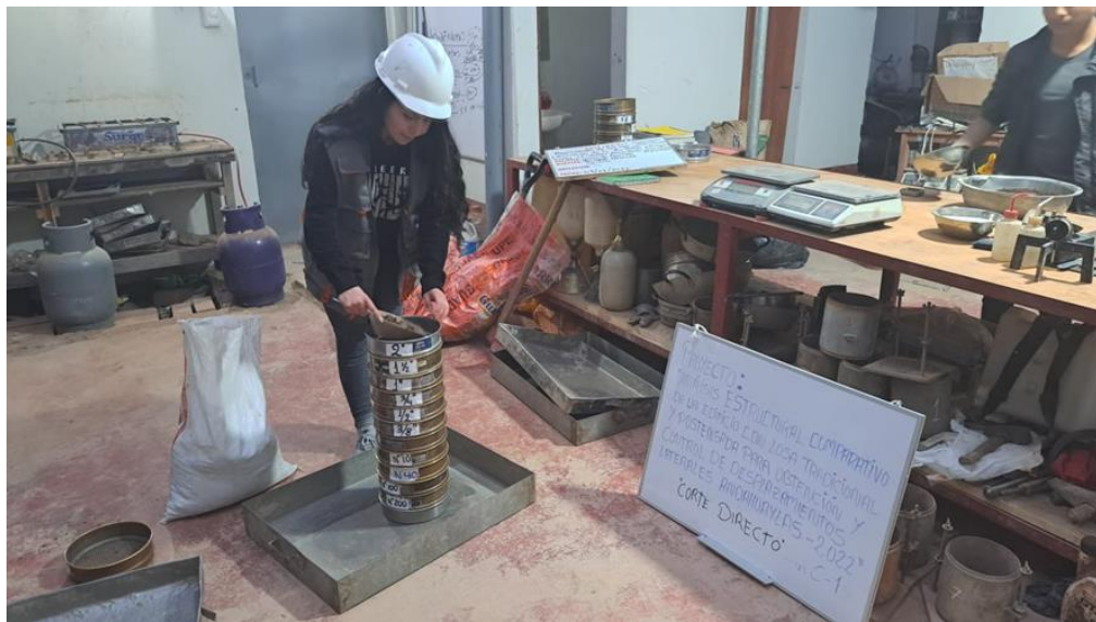
Figura 03: Tamizado de muestra de suelo seco para análisis granulométrico.
