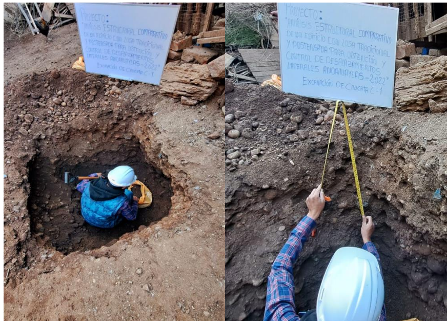
Figura 06: Medición de zanja para extracción de estratos de suelos.
