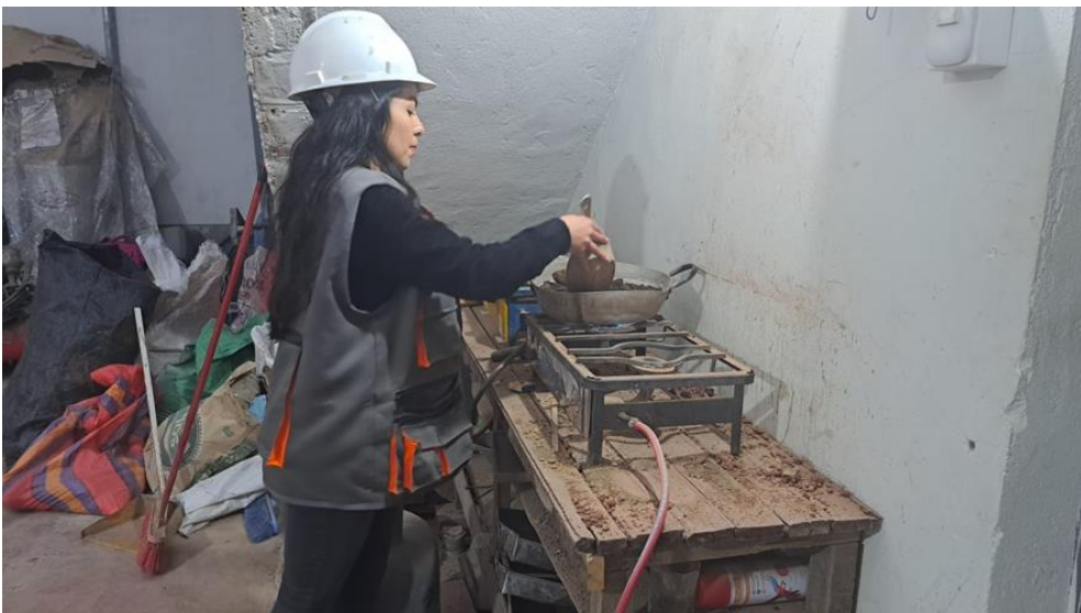
Figura 03: Secado de muestra de suelo para análisis granulométrico.
