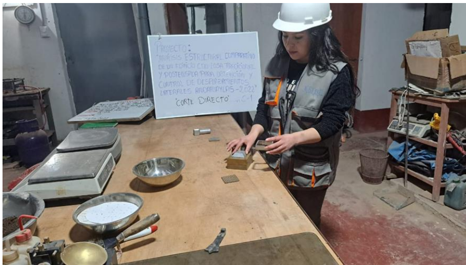
Figura 03: una vez compactado la muestra de suelo se procede a retirar los tornillos y caja de corte y llevarlo a la placa de transferencia de corte para su ensayo correspondiente.
