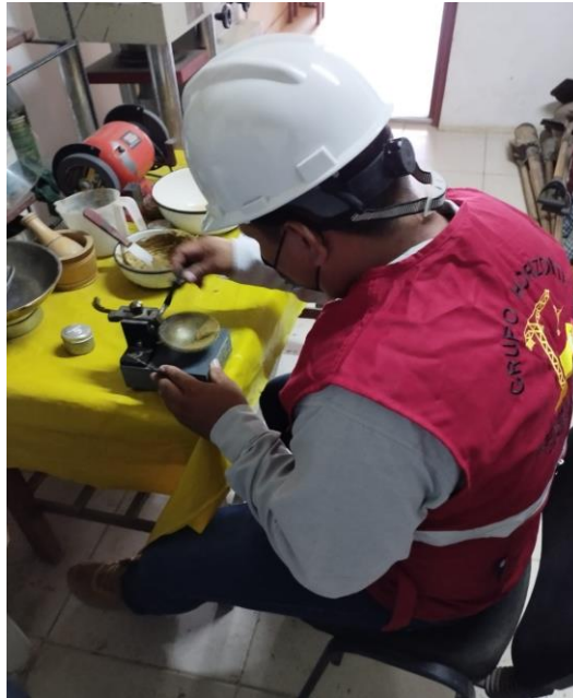
Figura 33: Midiendo límite líquido en la máquina Casagrande
