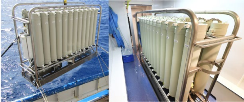
Figuur 4. Een foto van het NIOZ Titan ultra-schone monsternamesysteem terwijl het net uit zee komt aan boord van onderzoekschip Pelagia (links) en in de speciale lab-container (rechts). Het systeem is geheel gemaakt van plastic en titanium om verontreiniging te voorkomen. Monsters uit dit systeem worden alleen in speciale laboratoria, zogenaamde 'Clean rooms', opgewerkt en gemeten en de lab-container is een voorbeeld van zo'n clean room. Foto's gemaakt door Loes Gerringa, NIOZ.
