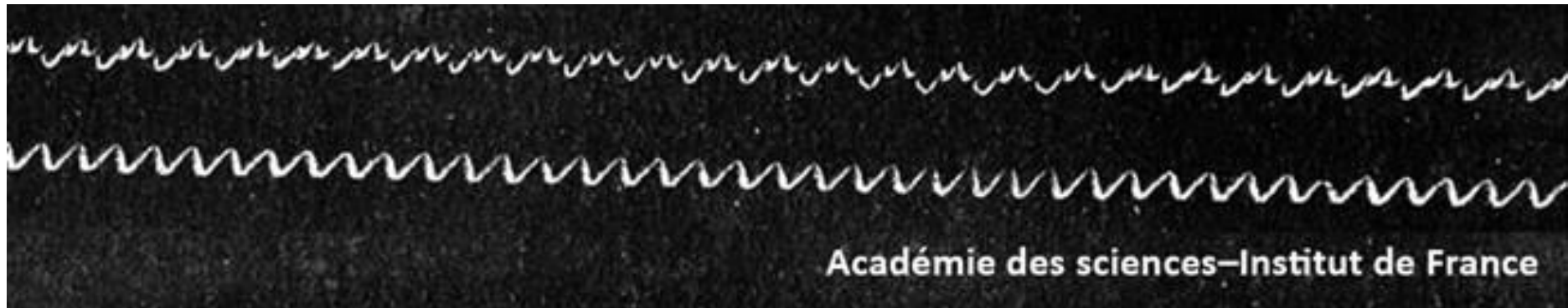
La frecuencia del sonido grabado en la traza superior podría determinarse contando las vibraciones inscritas por un diapasón de 250 Hz en la parte inferior. Académie des sciences-Institut de France. Cortesía del National Park Service, U.S. Dept. of the Interior. Recuperado de https://www.nps.gov/edis/learn/historyculture/images/1a-Scott-6.jpg?maxwidth=650&autorotate=false
