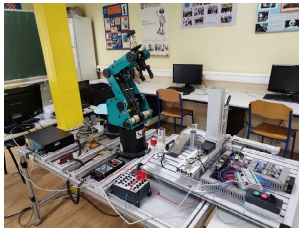
Slika 4: Prikaz sustava za automatsko sortiranje obratka i robotsko paletiziranje
