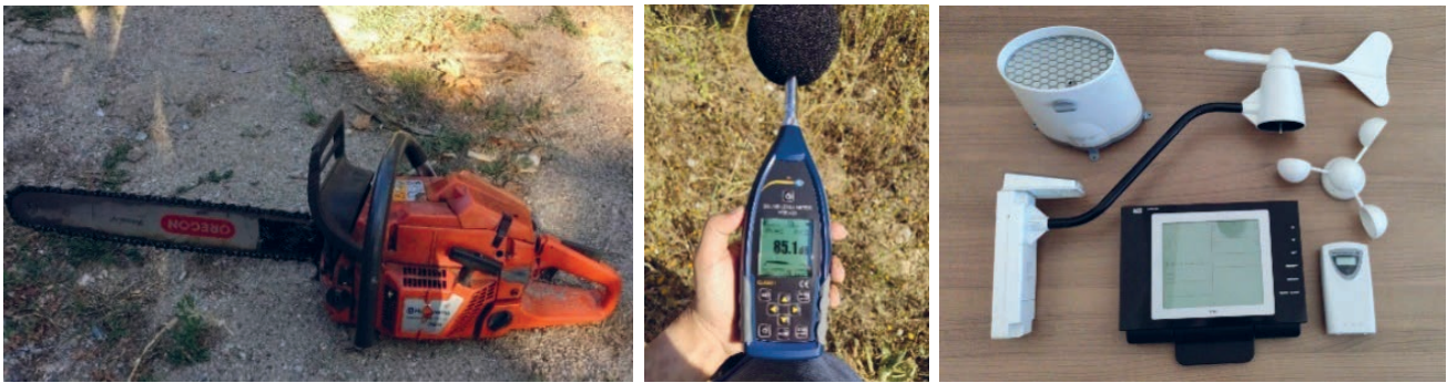
Figure 2. Devices used in the study: a) Chainsaw, b) Noise meter, c) Portable meteorology station Slika 2. Uređaji korišteni u studiji: a) motorna pila, b) zvukomjer, c) prijenosna meteorološka stanica
