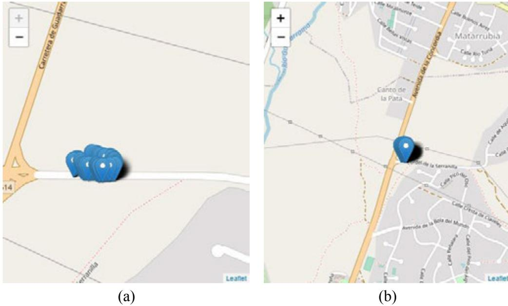
Fig. 4.24. Representación en un mapa de la transformación de los datos del LIDAR a coordenadas geodésicas WGS-84. Experimento 2.
