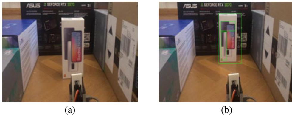
Fig. 4.29. Imagen representativa de dos escenas adyacentes durante una secuencia en la que se ha detectado un objeto en movimiento mediante la técnica de sustracción de imágenes. a) Imagen en  $t-1$ . b) Imagen en  $t$ .
