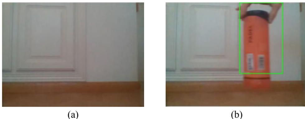
Fig. 4.26. Representación de la detección de movimiento basada en sustracción de imágenes.
