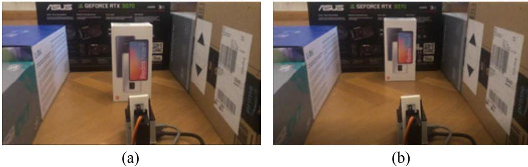
Fig. 4.13. Imagen representativa de dos escenas adyacentes durante una secuencia en la que un objeto rectangular se aleja del sensor LIDAR. a) Imagen en  $t-1$ . b) Imagen en  $t$ .
