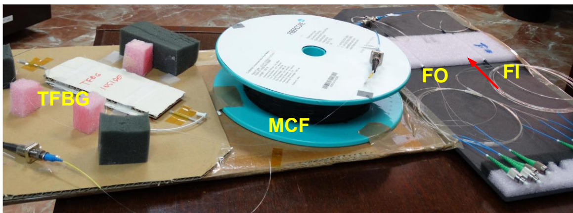
Figura 6.44 Montaje del experimento de la técnica de monitorización PoF.
