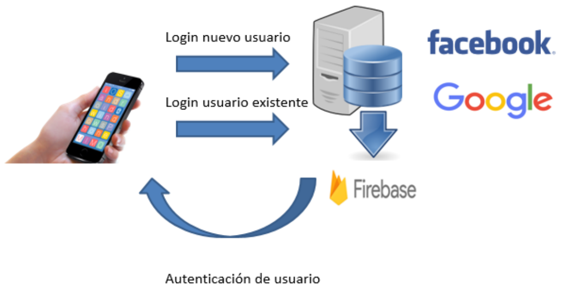
Figura 47: Arquitectura del módulo de login
