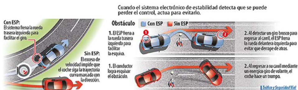
Fig. 2.9. Actuación del sistema ESP [16].
