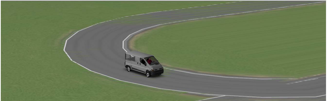
Fig. 6.7. Test 1 y Test 3: Rotonda de radio 22 m.
