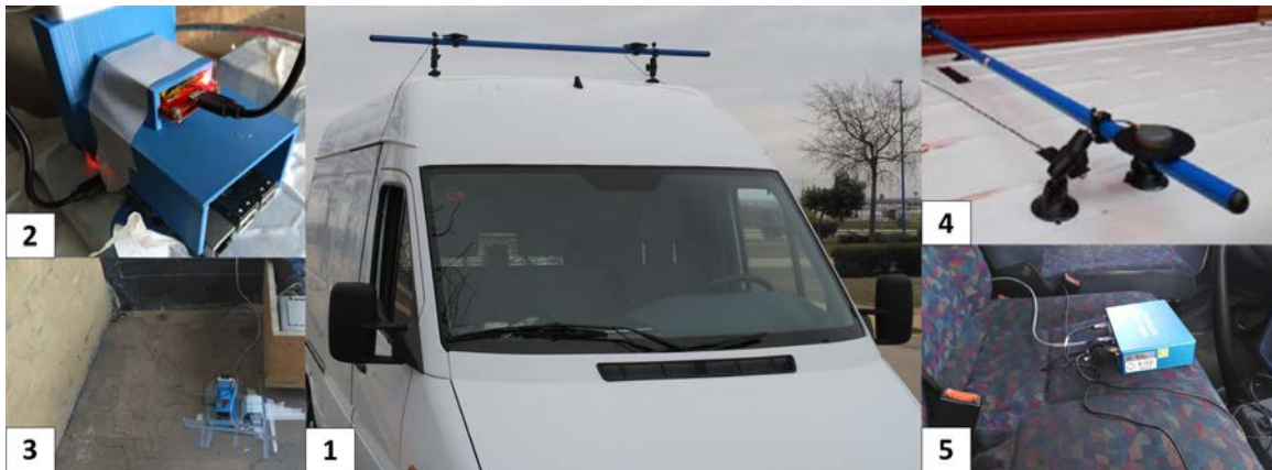
Fig. 5.2. Vehículo de prueba (1) equipado con: los dos kits de bajo coste y el IMU de Racelogic (2) ubicados en el centro de gravedad del vehículo (3), antena dual GPS (4) y VBOX data logger (5).
