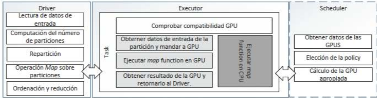
Fig. 1. Flujo general de una aplicación de GPU dentro de Spark.
